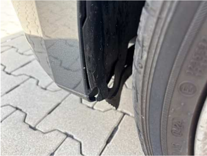
Stoßstange vorne (Riss/Bruch)
