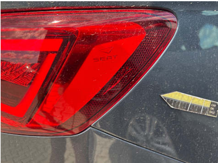
Rücklicht (rechts) (Riss/Bruch)
