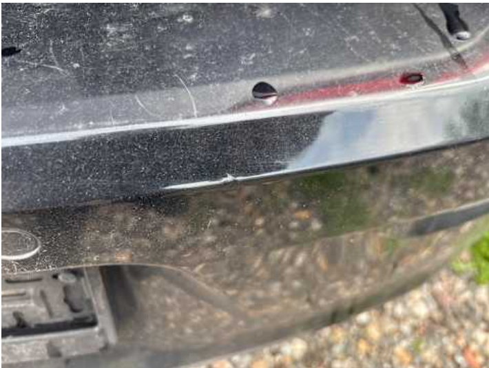
Stoßstange hinten (Kratzer, Lackschaden, Unsachgemäß instand gesetzt)
