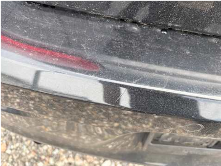
Stoßstange hinten (Kratzer, Lackschaden, Unsachgemäß instand gesetzt)
