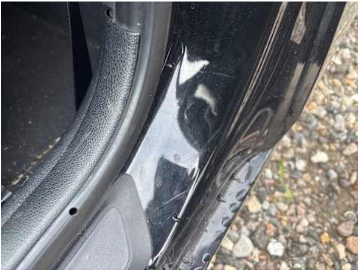
Schweller links (Kratzer)
