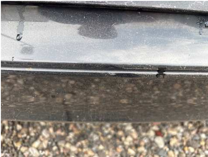
Stoßstange hinten (Kratzer, Lackschaden, Unsachgemäß instand gesetzt)
