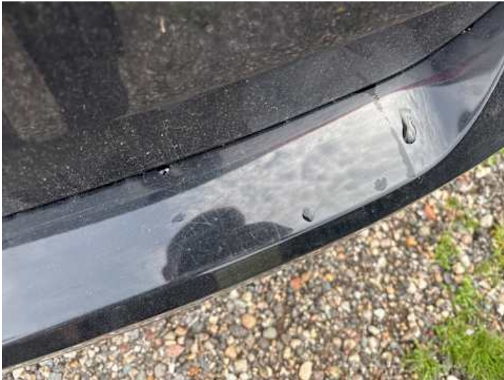
Stoßstange hinten (Kratzer, Lackschaden, Unsachgemäß instand gesetzt)
