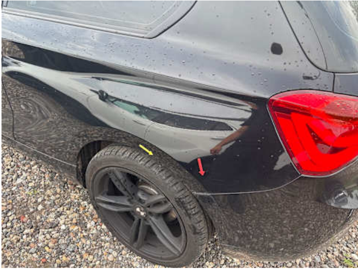
Seitenteil hinten links (Lackschaden, Kratzer)
