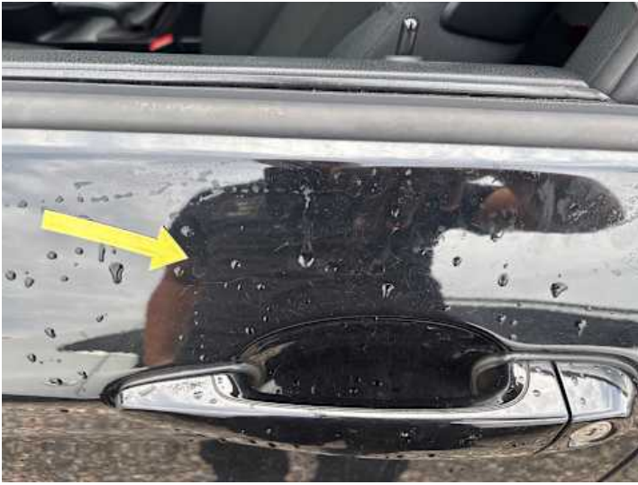
Fahrtür (Kratzer, Lackschaden, Delle)
