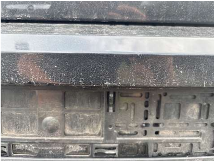
Stoßstange hinten (Kratzer, Lackschaden, Unsachgemäß instand gesetzt)
