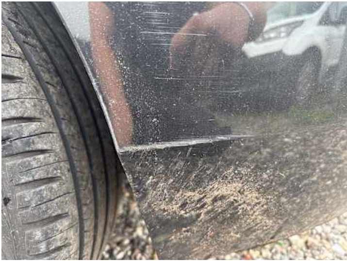
Stoßstange hinten (Kratzer, Lackschaden)
