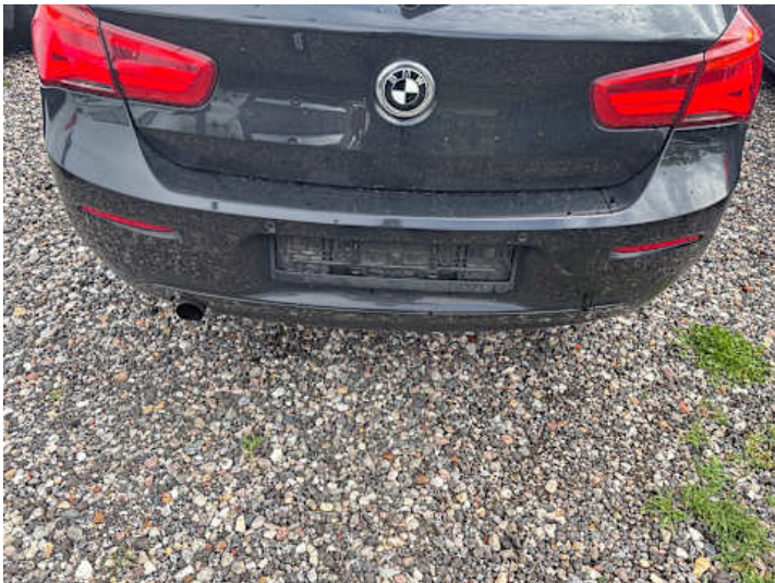
Stoßstange hinten (Kratzer, Lackschaden, Unsachgemäß instand gesetzt)
