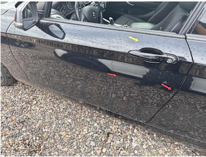
Fahrrertür (Kratzer, Lackschaden, Delle)
