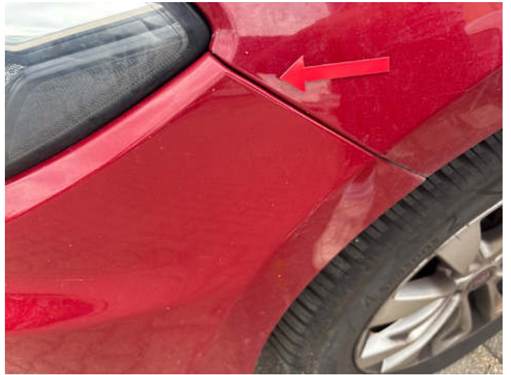
Stoßstange vorne (Spaltmaße ungenau)
