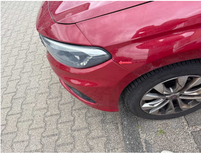
Stoßstange vorne (Spaltmaße ungenau)
