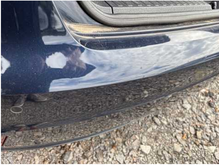
Stoßstange hinten (Kratzer, Delle)
