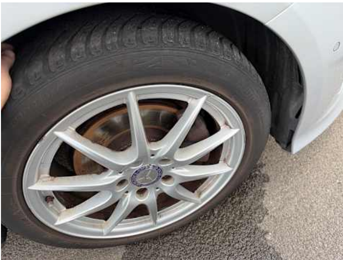
Rad (Kratzer, Ungleichmäßig abgefahren, Kerben)
