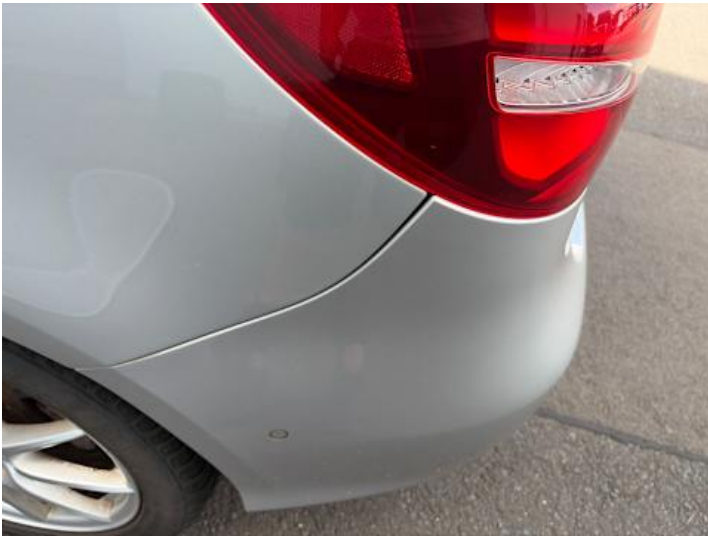
Stoßstange hinten (Spaltmaße ungenau)
