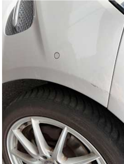
Stoßstange vorne (Kratzer, Lackschaden)
