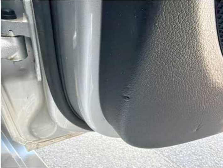
Innenraum (Kratzer, Riss/Bruch)
