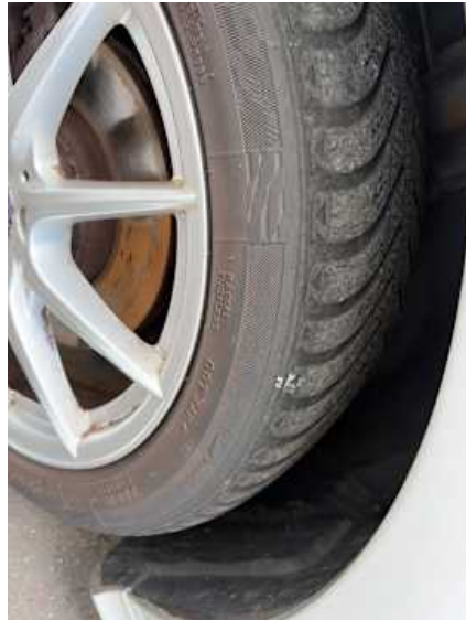
Rad (Ungleichmäßig abgefahren)
