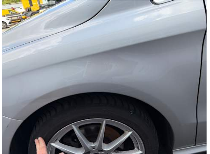
Kotflügel vorne links (Kratzer, Lackschaden, Verformung)
