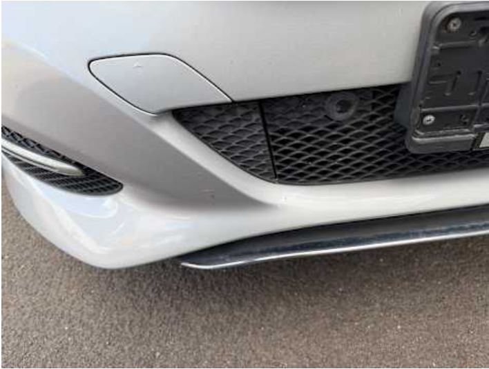
Stoßstange vorne (Steinschlag, Lackschaden)
