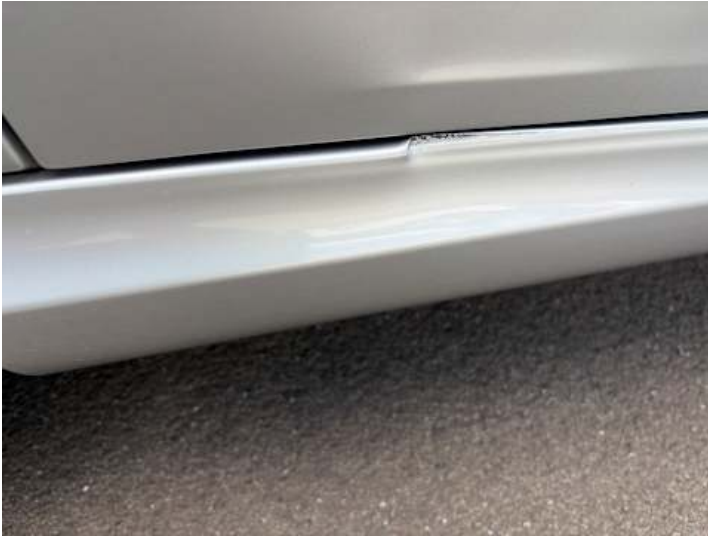
Schweller rechts (Riss/Bruch, Verformung)
