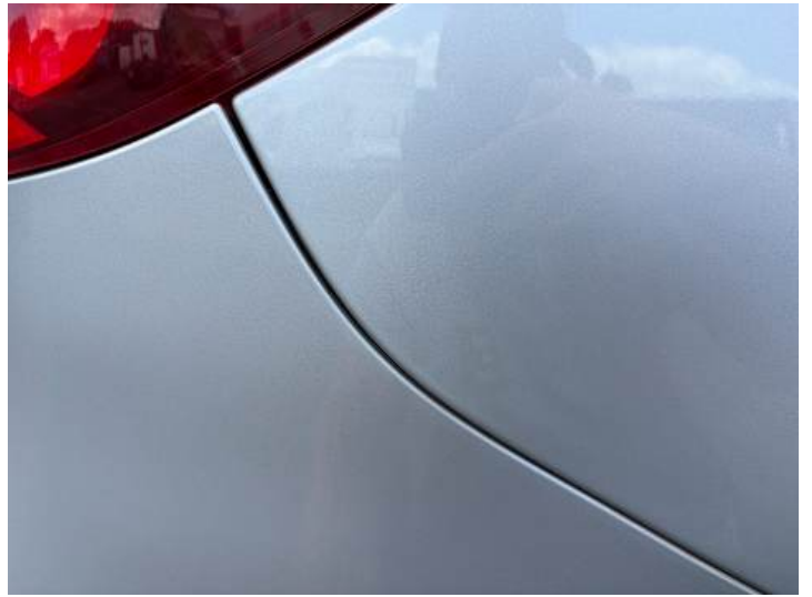
Stoßstange hinten (Spaltmaße ungenau)
