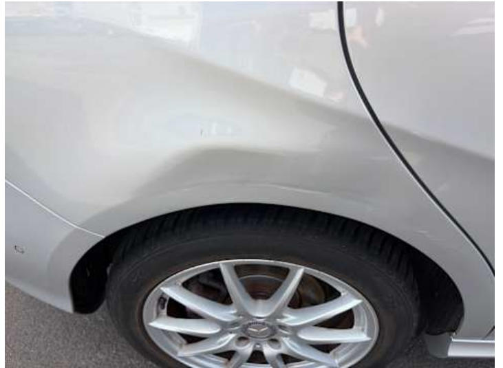
Seitenteil hinten rechts (Kratzer, Lackschaden, Verformung)
