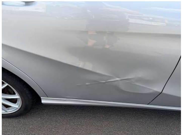
Türe hinten rechts (Verformung, Lackschaden, Delle, Kratzer)
