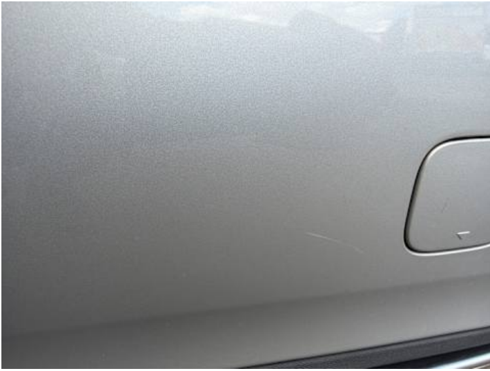
Stoßstange hinten (Kratzer)
