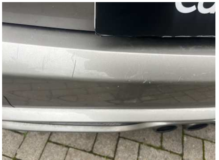
Stoßstange hinten (Kratzer, Lackschaden)
