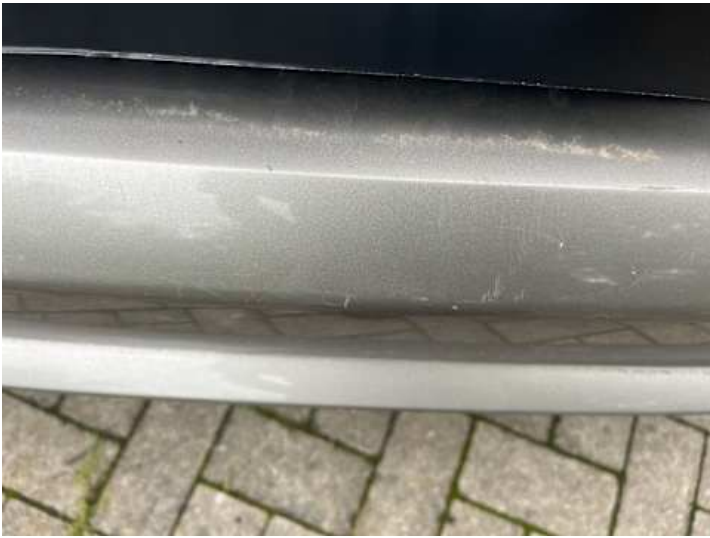
Stoßstange hinten (Kratzer, Lackschaden)
