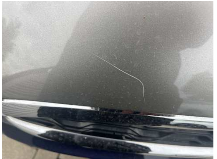
Motorhaube (Kratzer, Lackschaden)
