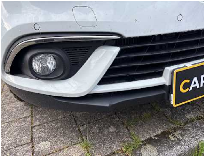
Stoßstange vorne (Verformung)
