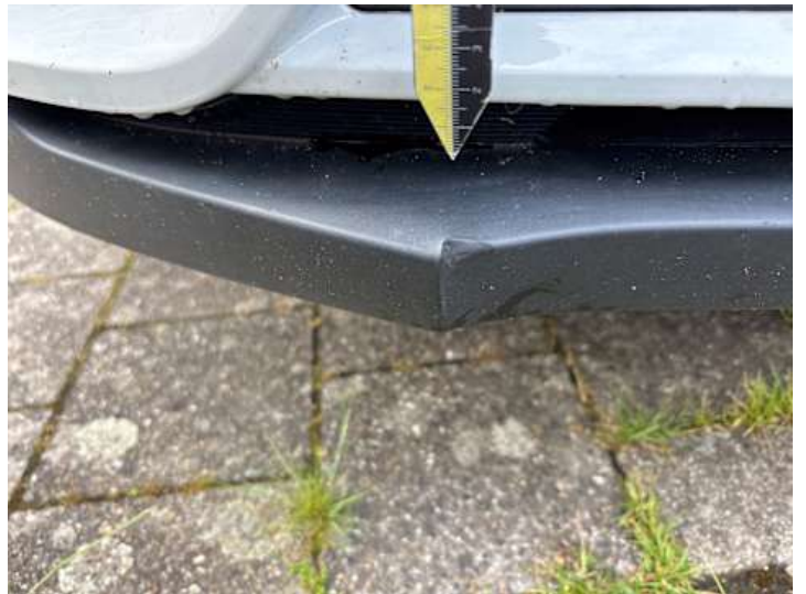
Stoßstange vorne (Verformung)
