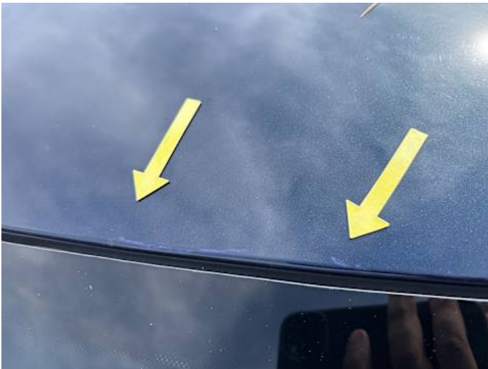
Dach (Lackschaden, Rost)
