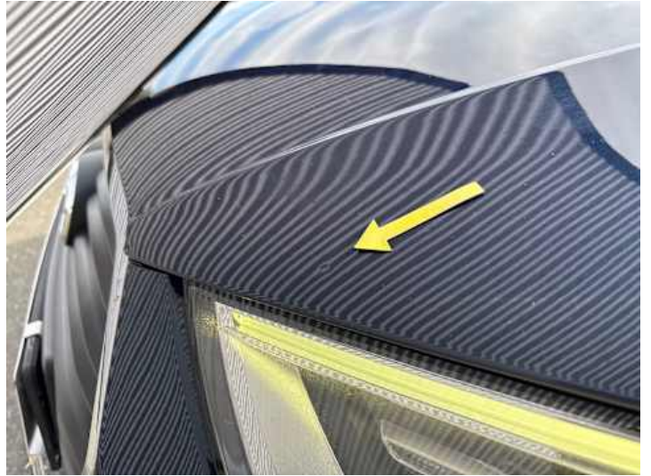
Motorhaube (Delle, Lackschaden)
