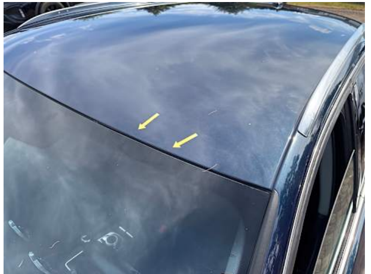
Dach (Lackschaden, Rost)
