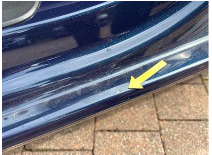
Schweller links (Rost, Lackschaden)
