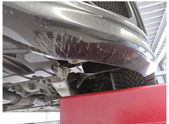
Stoßfänger vorne - SmartRepair
