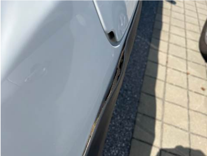
Seitenteil hinten rechts (Spaltmaße ungenau)
