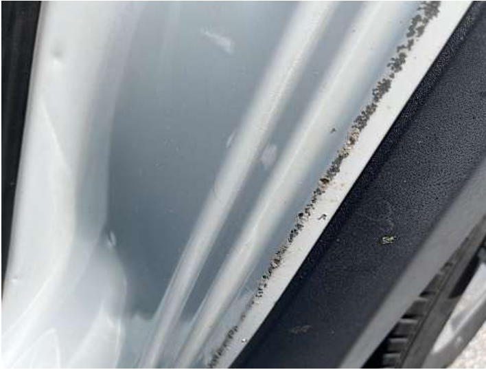
Seitenteil hinten links (Lackschaden, Delle)
