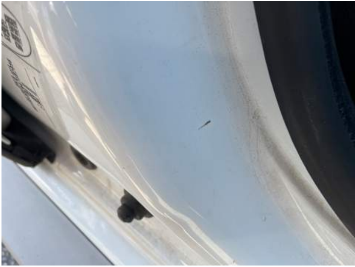
Schweller rechts (Kratzer)
