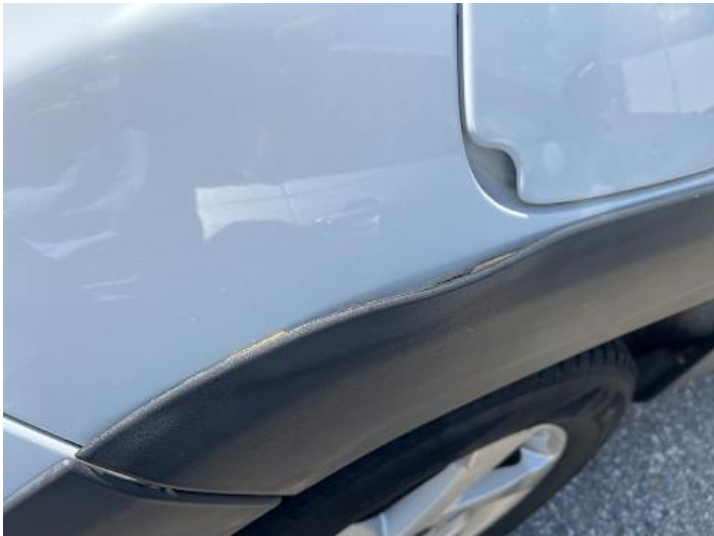
Seitenteil hinten rechts (Spaltmaße ungenau)
