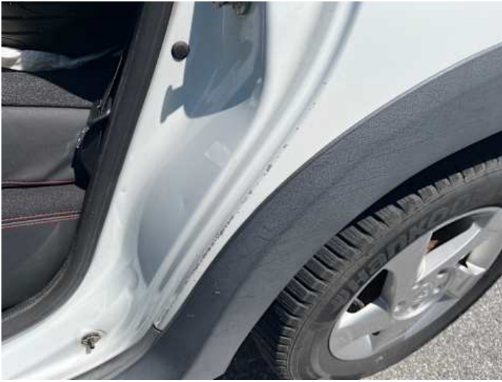
Seitenteil hinten links (Lackschaden, Delle)
