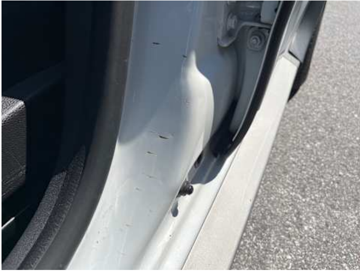
Schweller links (Kratzer, Delle)
