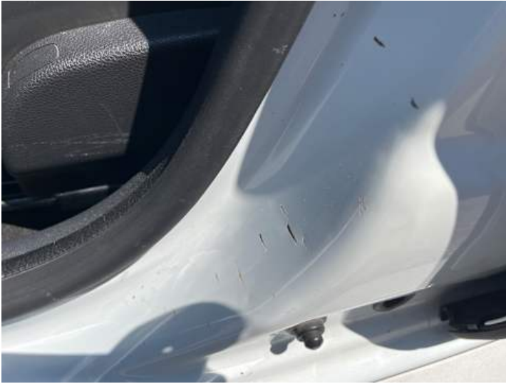
Schweller links (Kratzer, Delle)
