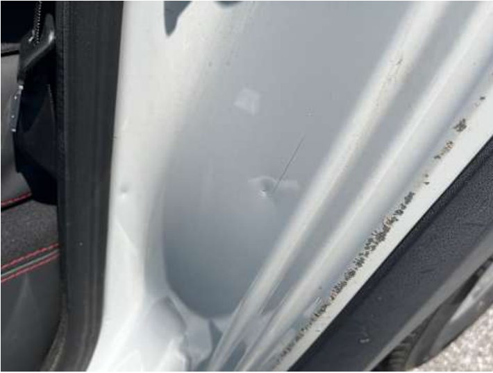
Seitenteil hinten links (Lackschaden, Delle)
