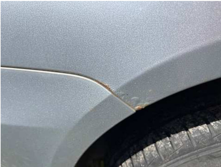
Seitenteil hinten rechts (Rost)
