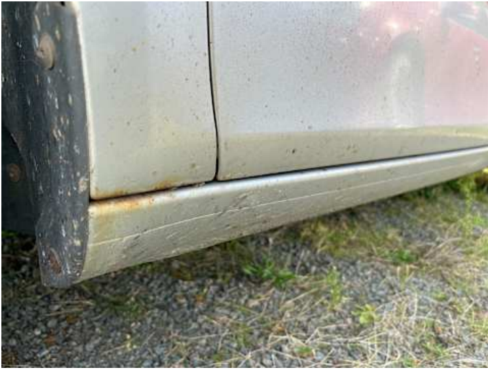
Schweller links (Rost)
