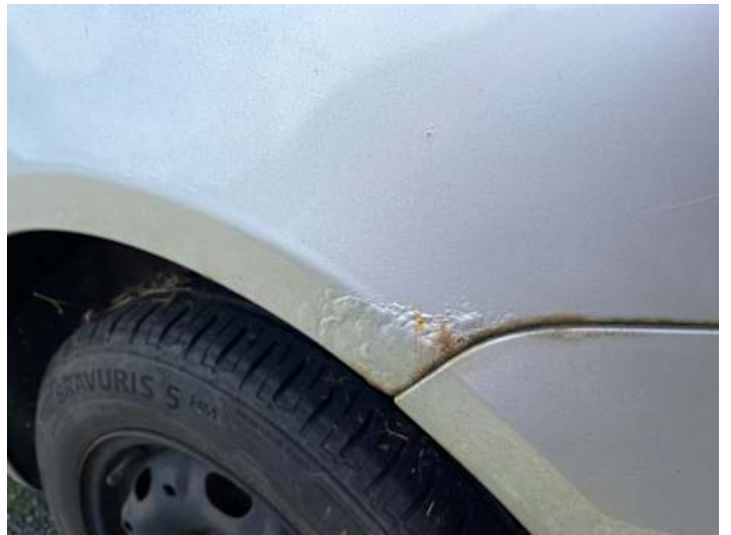
Seitenteil hinten links (Rost)
