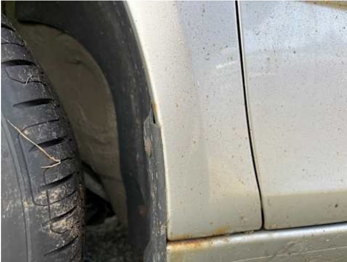
Kotflügel vorne links (Kratzer, Rost)
