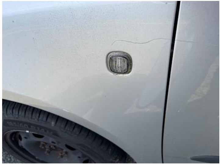
Kotflügel vorne links (Kratzer, Rost)
