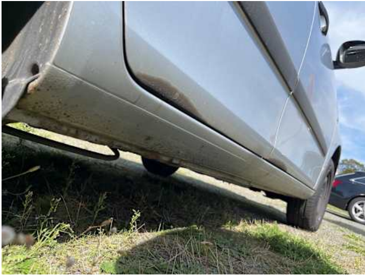
Schweller rechts (Rost)
