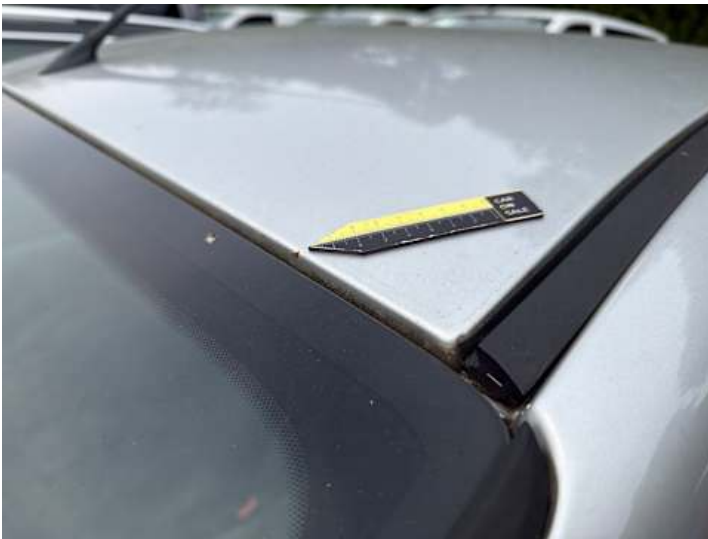
Dach (Steinschlag, Rost)
