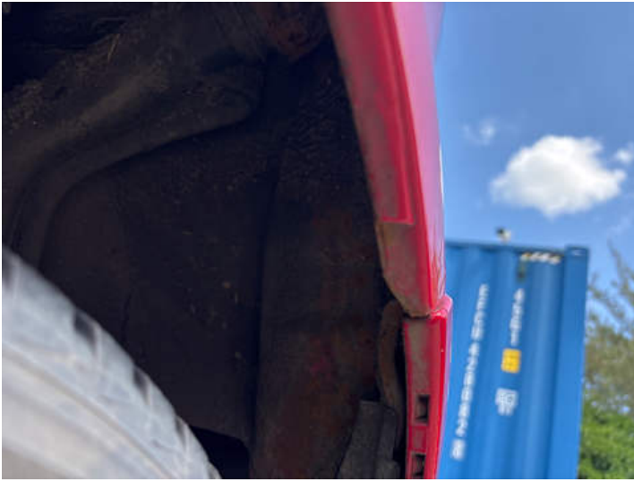
Seitenteil hinten links (Lackschaden, Rost)
