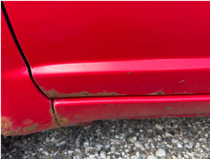
Fahrtür (Kratzer, Lackschaden, Delle, Rost)
