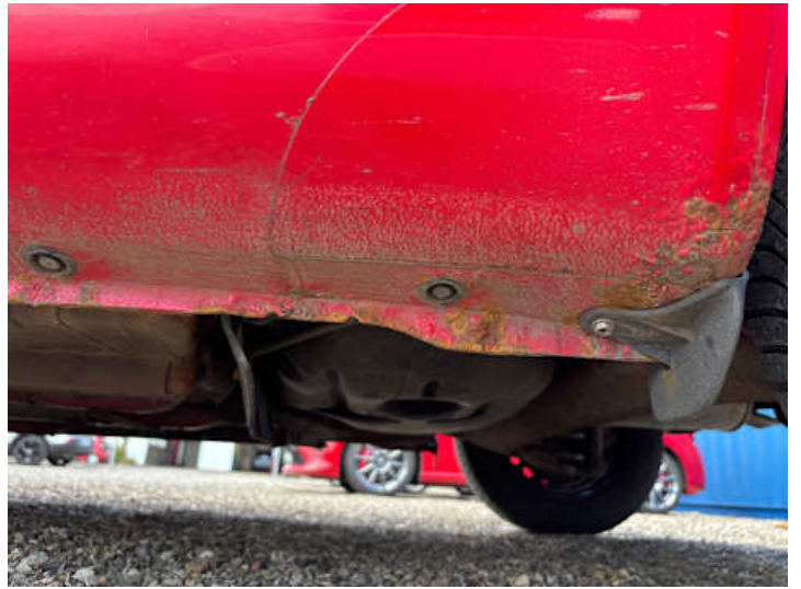
Schweller links (Kratzer, Lackschaden, Delle, Rost)
