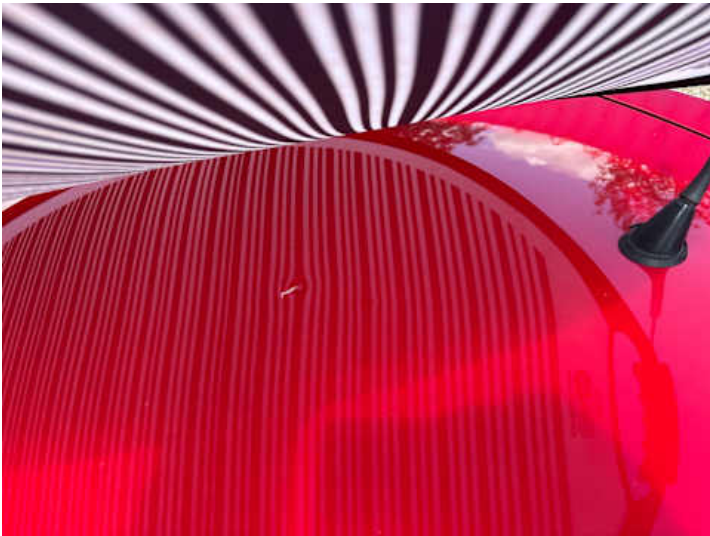
Dach (Delle, Kratzer, Lackschaden)
