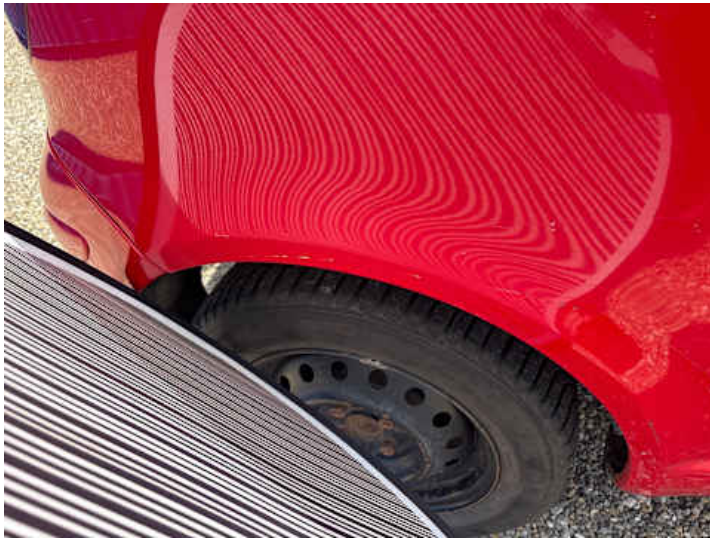
Seitenteil hinten rechts (Kratzer, Lackschaden, Delle)
