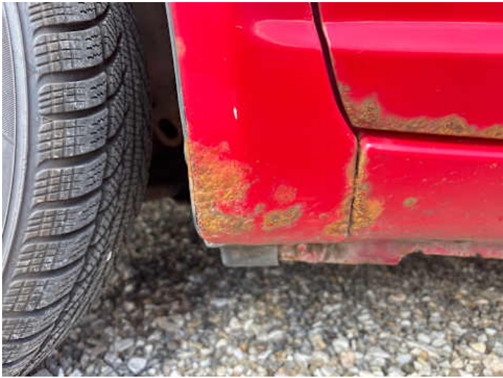
Kotflügel vorne links (Lackschaden, Rost, Kratzer, Delle)
