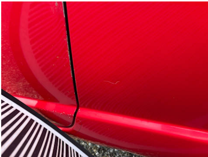
Seitenteil hinten links (Delle, Kratzer, Lackschaden)
