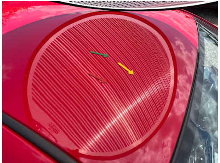
Dach (Delle, Kratzer, Lackschaden)
