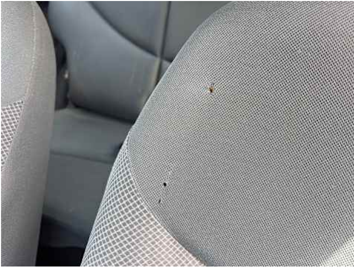
Innenraum (Riss/Bruch, Brandloch)
