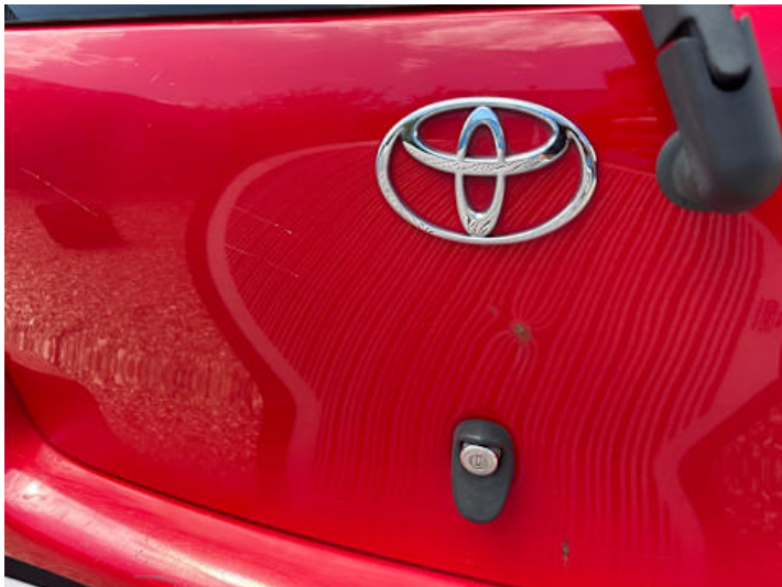
Heckklappe (Kratzer, Delle, Lackschaden, Rost)
