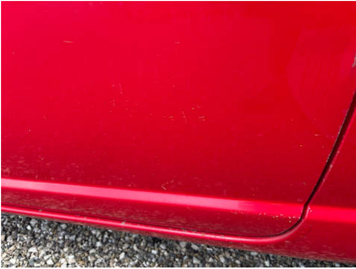
Fahrtür (Kratzer, Lackschaden, Delle, Rost)
