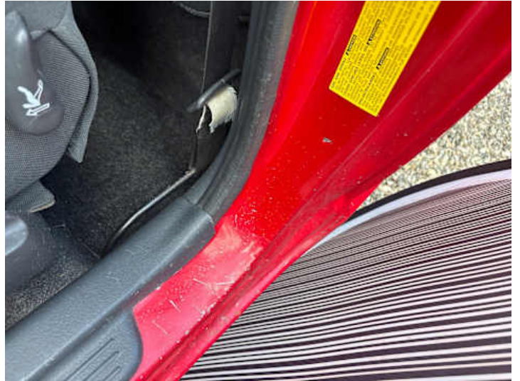
Schweller links (Kratzer, Lackschaden, Delle, Rost)
