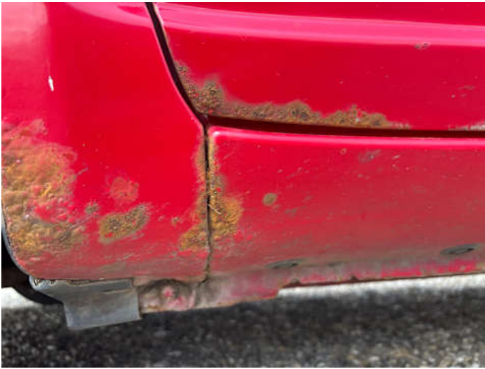
Schweller links (Kratzer, Lackschaden, Delle, Rost)
