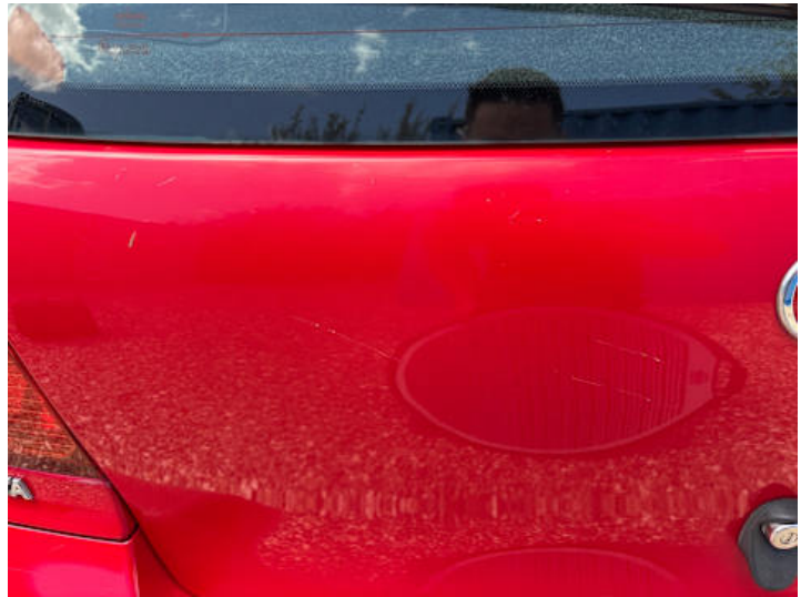
Heckklappe (Kratzer, Delle, Lackschaden, Rost)
