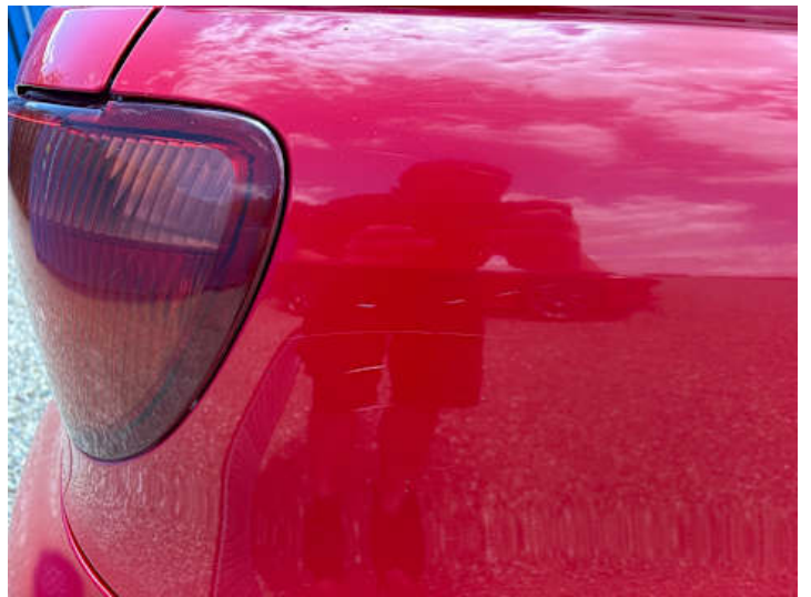
Seitenteil hinten rechts (Kratzer, Lackschaden, Delle)
