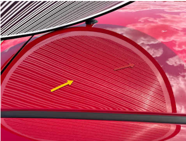
Dach (Delle, Kratzer, Lackschaden)
