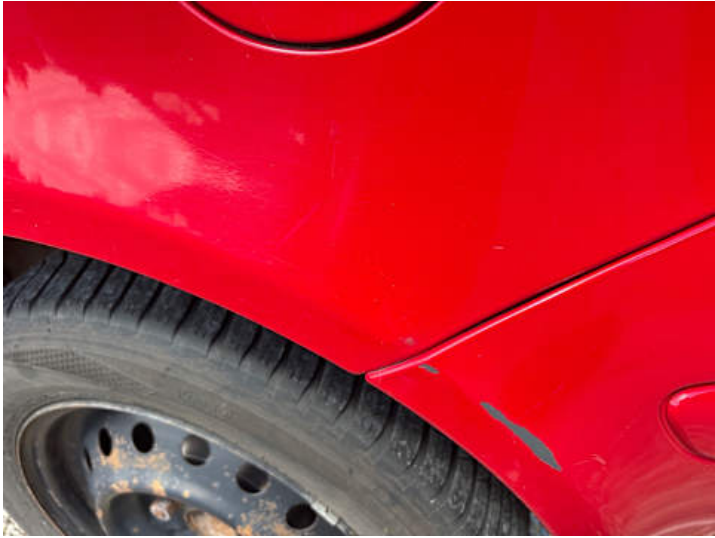
Seitenteil hinten links (Lackschaden, Rost)
