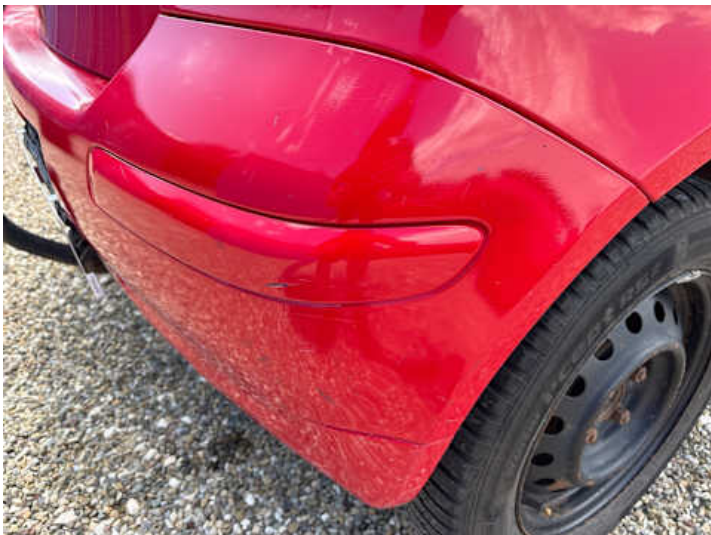
Stoßstange hinten (Kratzer, Lackschaden, Unsachgemäß instand gesetzt, Ausgeblichen/Matt, Delle, Riss/Bruch)
