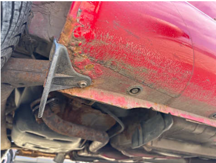
Schweller rechts (Lackschaden, Rost)
