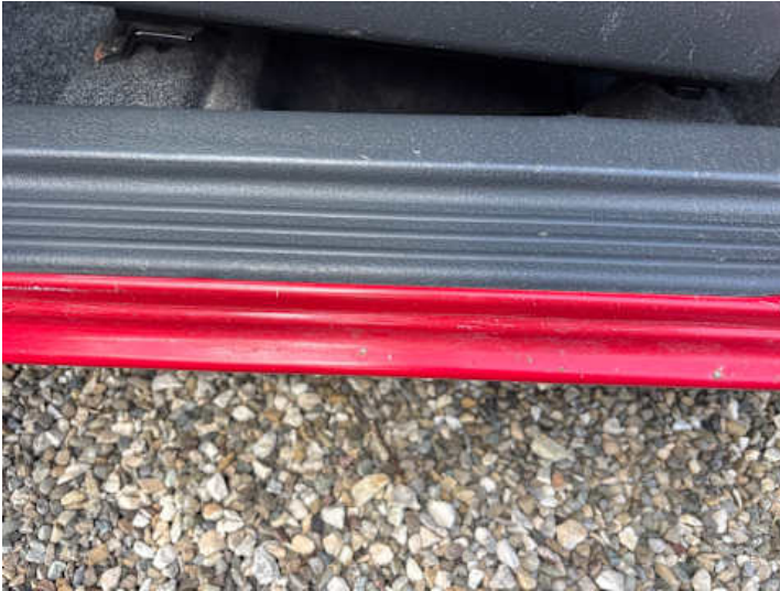
Schweller links (Kratzer, Lackschaden, Delle, Rost)
