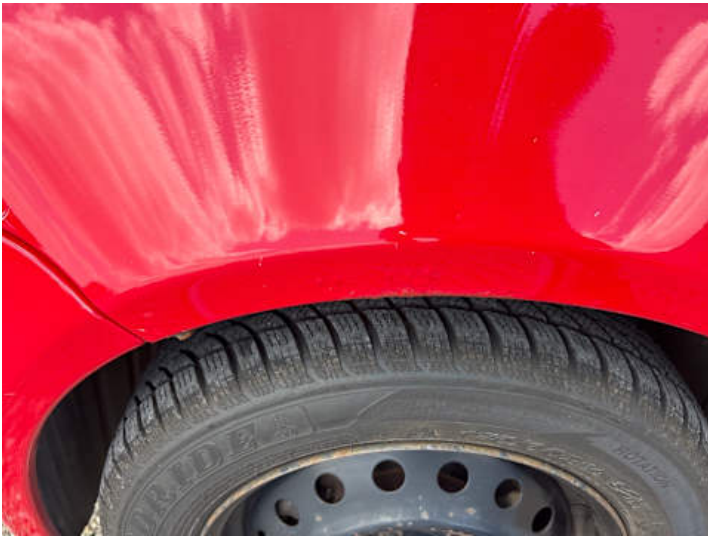
Kotflügel vorne links (Lackschaden, Rost, Kratzer, Delle)
