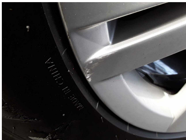
Beschädigung 5: Rad/Reifen: Leichtmetallfelge hinten links - verkratzt / verschürft - Wertminderung
