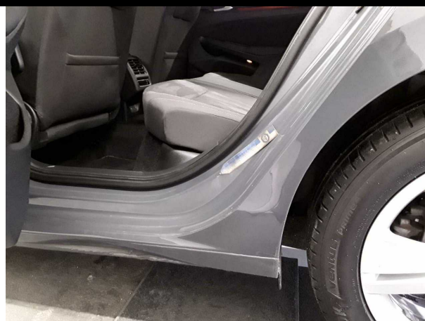
Gebrauchsspur 2: Seitenwand links: Einstieg - Kratzer - kein Abzug
