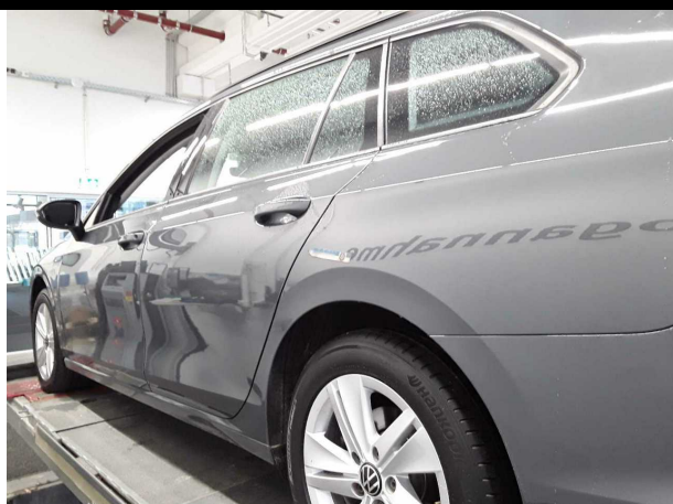
Gebrauchsspur 1: Seitenwand links: Seitenwand - Delle(n) - kein Abzug
