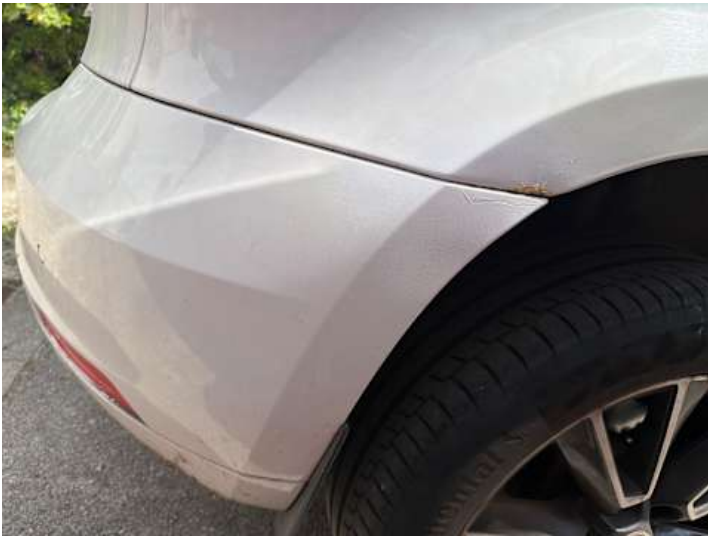
Stoßstange hinten (Unsachgemäß instand gesetzt)
