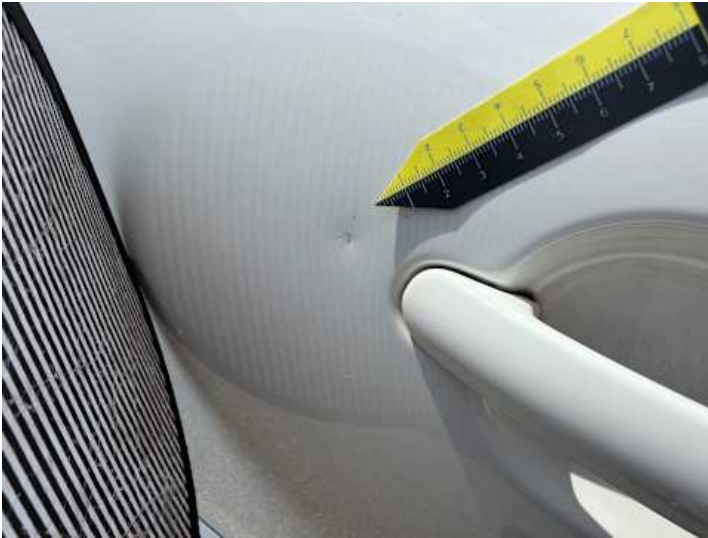
Fahrtür (Delle, Kratzer)
