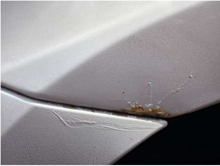
Seitenteil hinten rechts (Rost, Unsachgemäß instand gesetzt)
