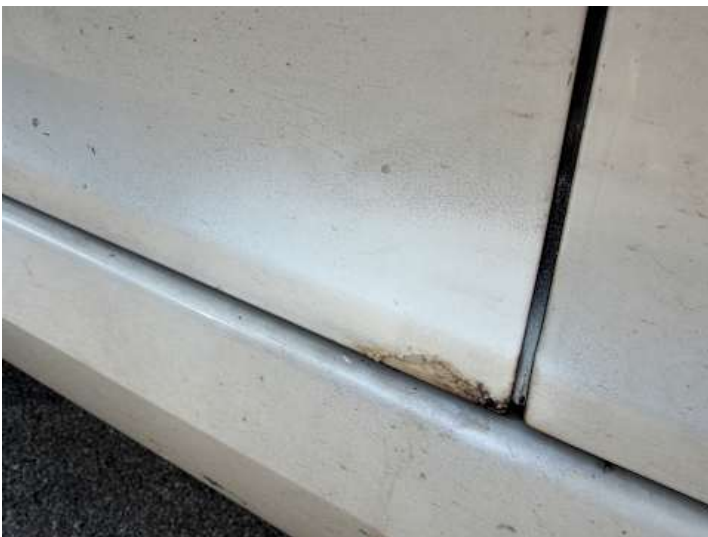
Fahrtür (Rost, Unsachgemäß instand gesetzt)
