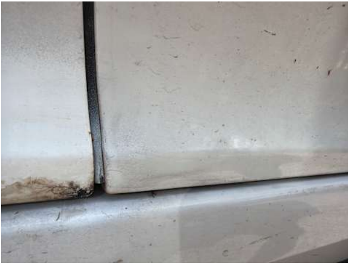
Türe hinten links (Unsachgemäß instand gesetzt)
