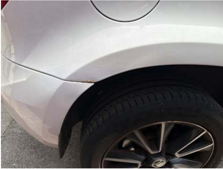
Seitenteil hinten rechts (Rost, Unsachgemäß instand gesetzt)
