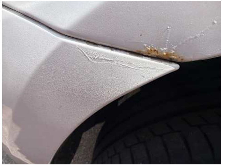
Stoßstange hinten (Unsachgemäß instand gesetzt)
