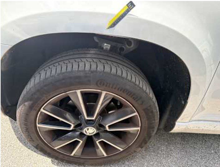
Kotflügel vorne links (Unsachgemäß instand gesetzt, Rost)
