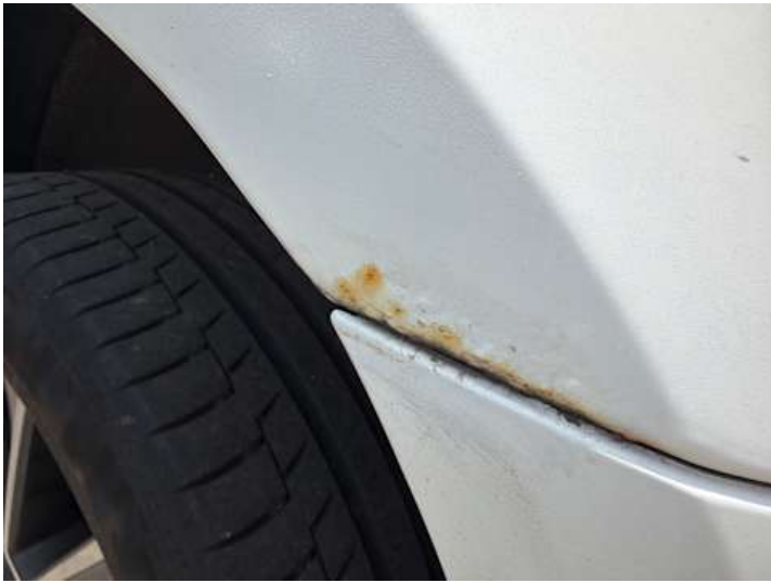
Seitenteil hinten links (Rost, Unsachgemäß instand gesetzt)
