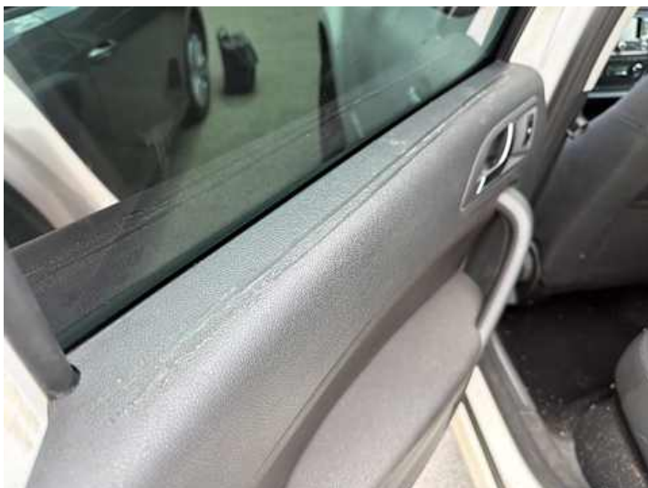
Innenraum (Anderer Schaden): Klebereste
