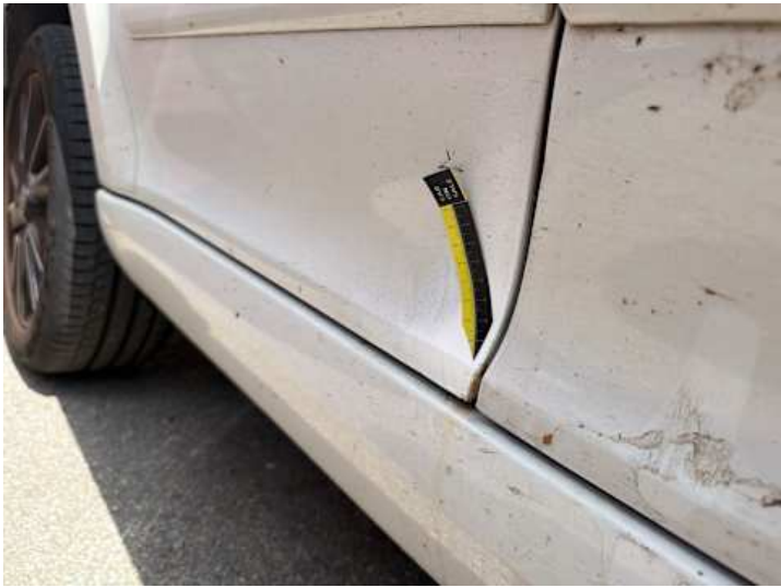
Türe hinten rechts (Rost, Unsachgemäß instand gesetzt)
