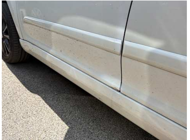
Fahrtür (Rost, Unsachgemäß instand gesetzt)
