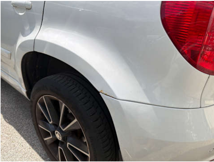
Seitenteil hinten links (Rost, Unsachgemäß instand gesetzt)
