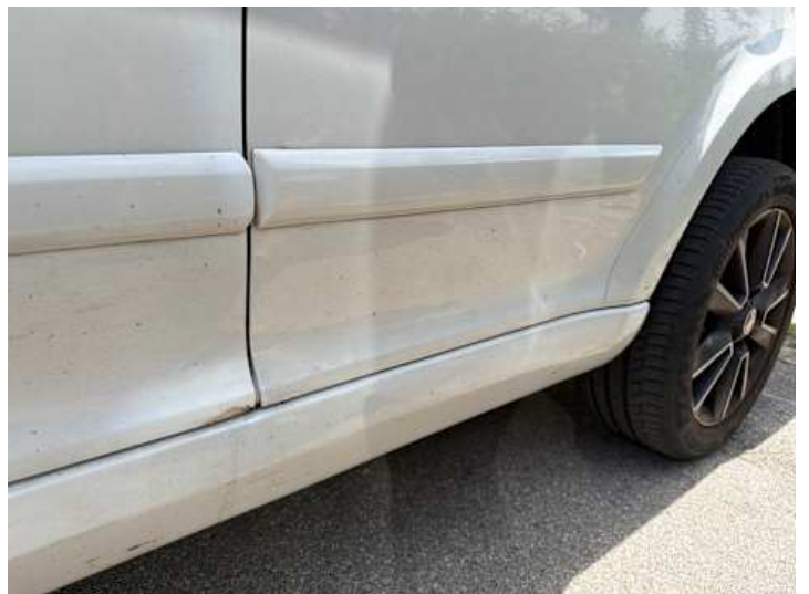
Türe hinten links (Unsachgemäß instand gesetzt)
