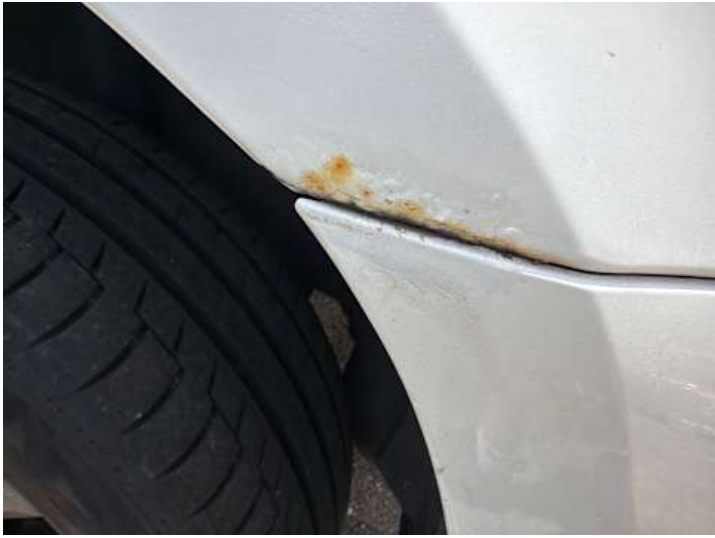
Stoßstange hinten (Unsachgemäß instand gesetzt)
