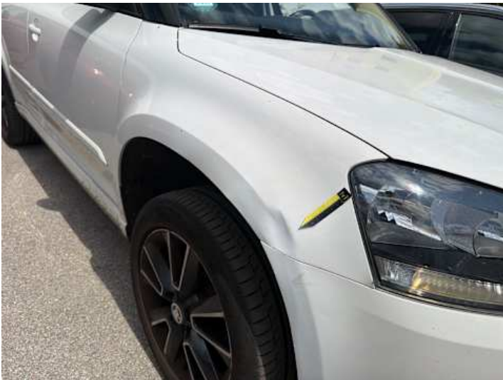
Kotflügel vorne rechts (Verformung, Unsachgemäß instand gesetzt)
