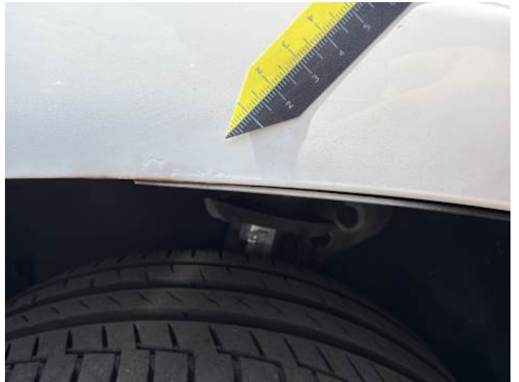
Kotflügel vorne links (Unsachgemäß instand gesetzt, Rost)
