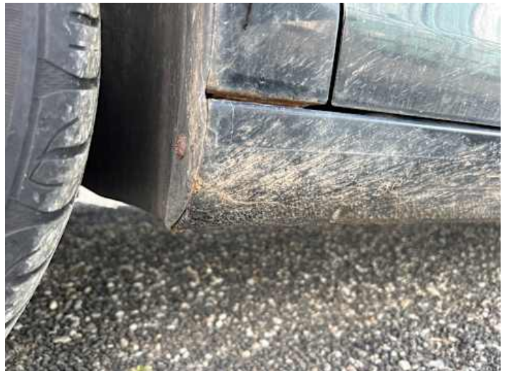
Schweller links (Rost)
