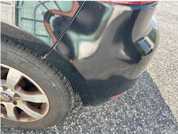
Stoßstange hinten (Unsachgemäß instand gesetzt)
