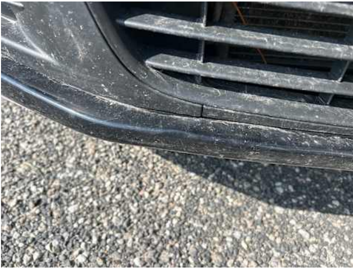
Stoßstange vorne (Kratzer, Verformung)
