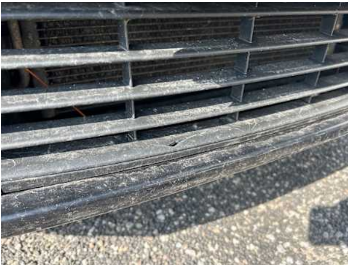
Stoßstange vorne (Riss/Bruch)
