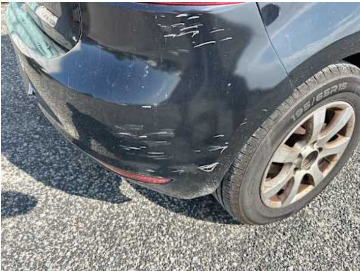
Stoßstange hinten (Kratzer, Lackschaden)
