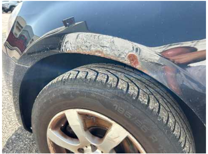
Kotflügel vorne links (Rost)
