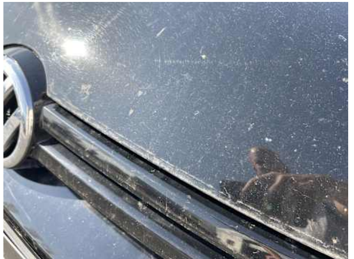
Motorhaube (Rost, Steinschlag)
