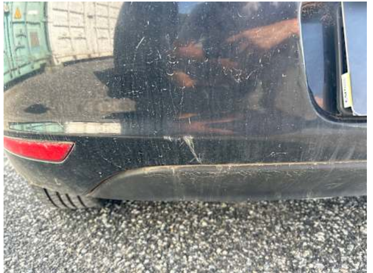
Stoßstange hinten (Kratzer)
