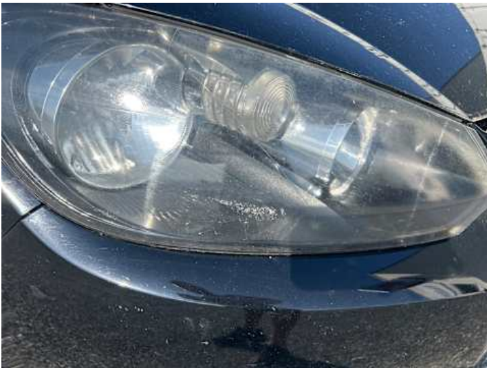
Scheinwerfer (rechts) (Blind, Riss/Bruch)
