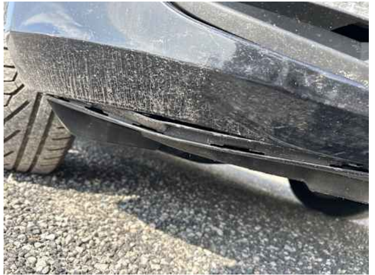
Stoßstange vorne (Riss/Bruch)
