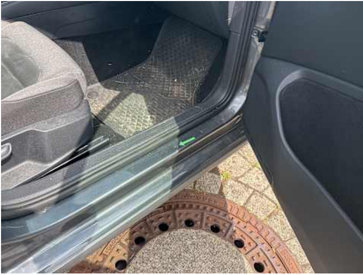
Schweller rechts (Delle, Lackschaden)
