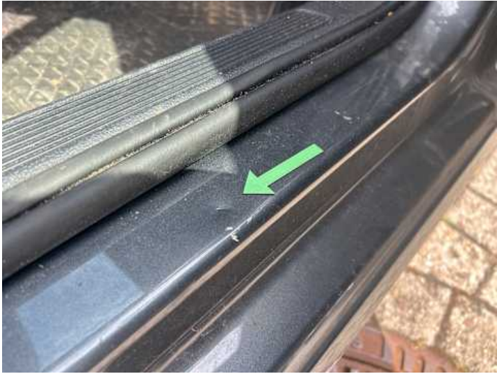
Schweller rechts (Delle, Lackschaden)
