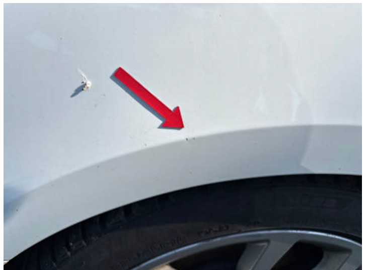
Seitenteil hinten rechts (Lackschaden)
