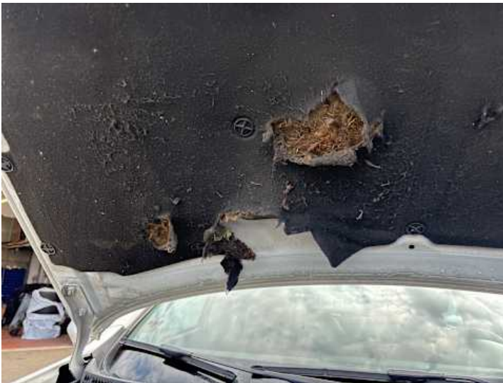
Motorhaube (Anderer Schaden): Dämmmatte angefressen
