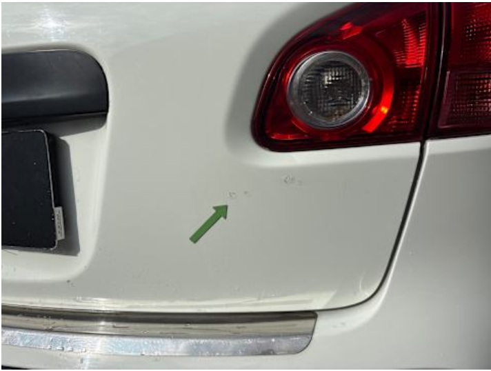
Heckklappe (Delle, Kratzer, Unsachgemäß instand gesetzt)
