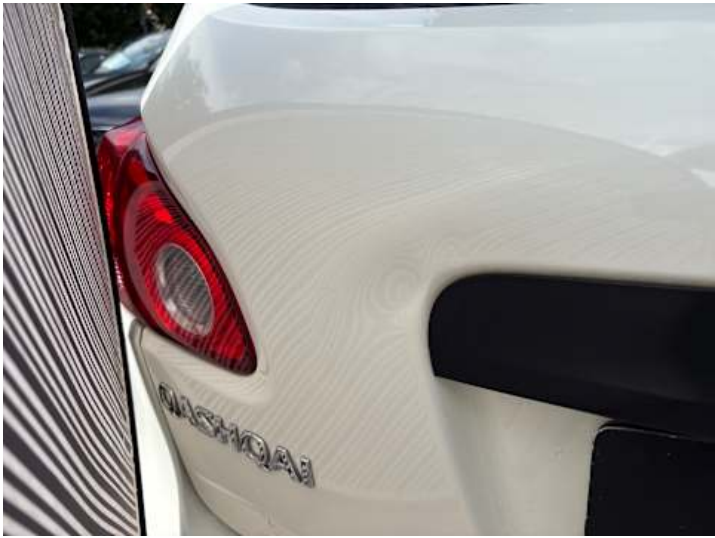
Heckklappe (Delle, Kratzer, Unsachgemäß instand gesetzt)
