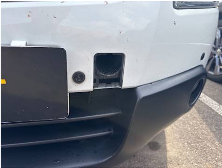
Stoßstange vorne (Kratzer, Anderer Schaden): Teil fehlt
