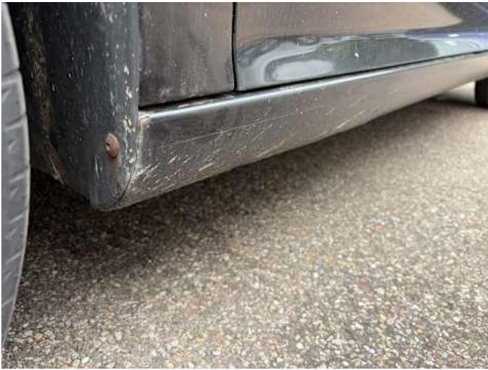
Schweller links (Rost)
