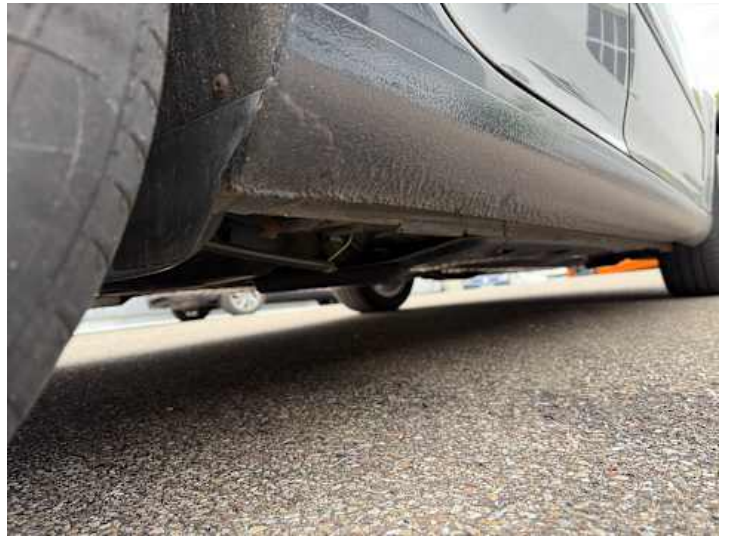
Schweller rechts (Rost)
