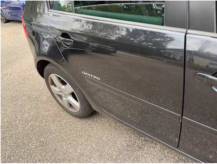
Türe hinten rechts (Kratzer, Delle)
