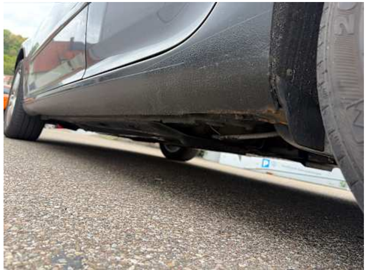
Schweller links (Rost)
