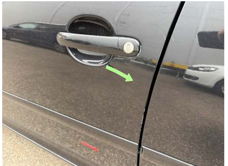
Fahrtür (Kratzer, Delle)
