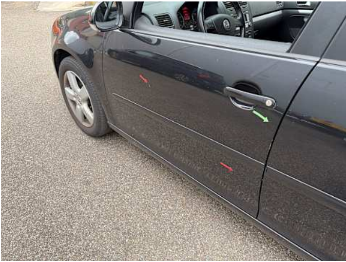
Fahrtür (Kratzer, Delle)
