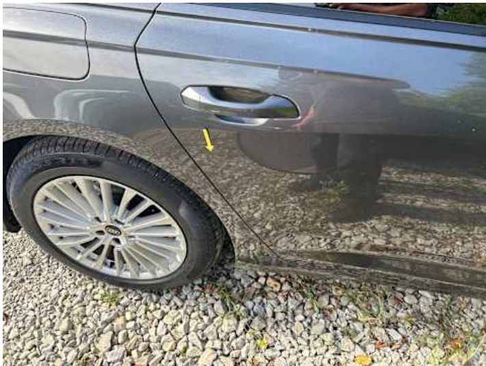
Türe hinten rechts (Lackschaden, Delle)
