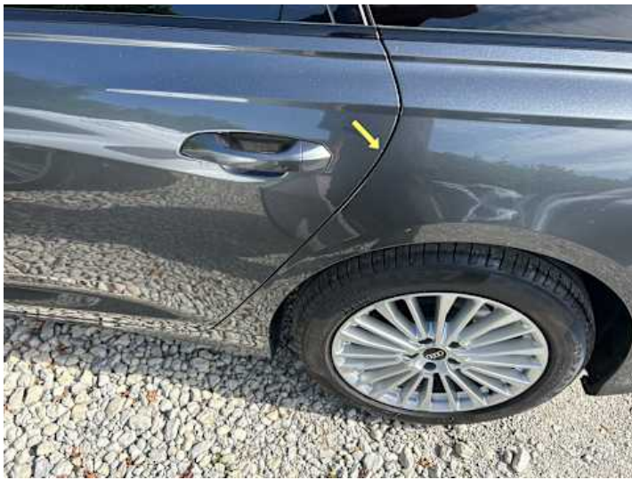
Türe hinten links (Lackschaden)
