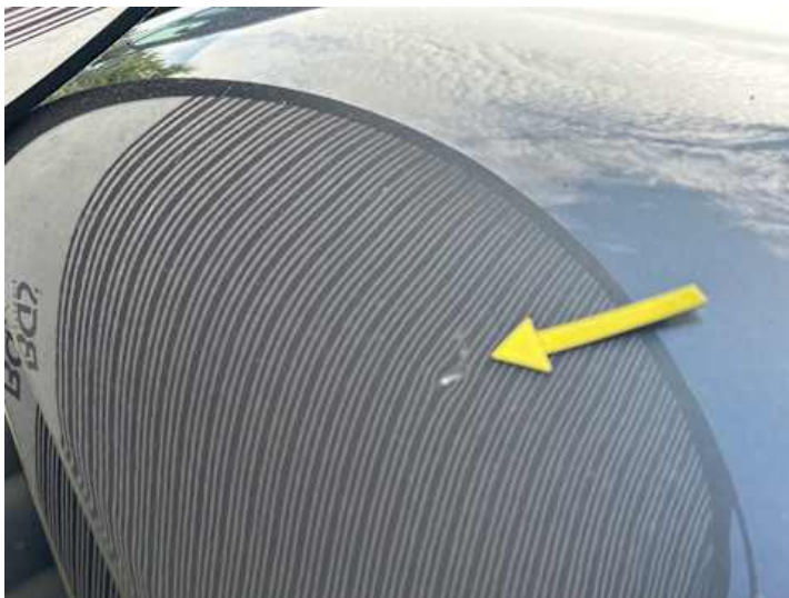
Motorhaube (Lackschaden, Delle)
