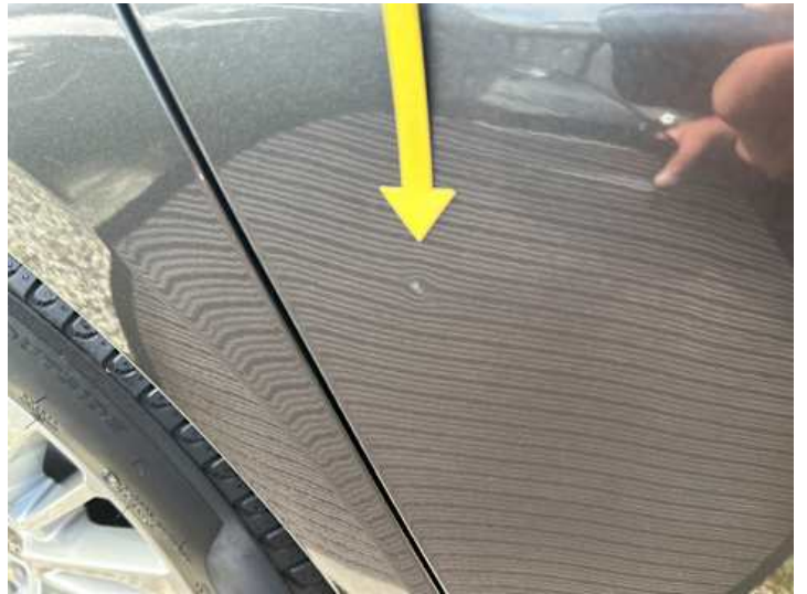
Türe hinten rechts (Lackschaden, Delle)
