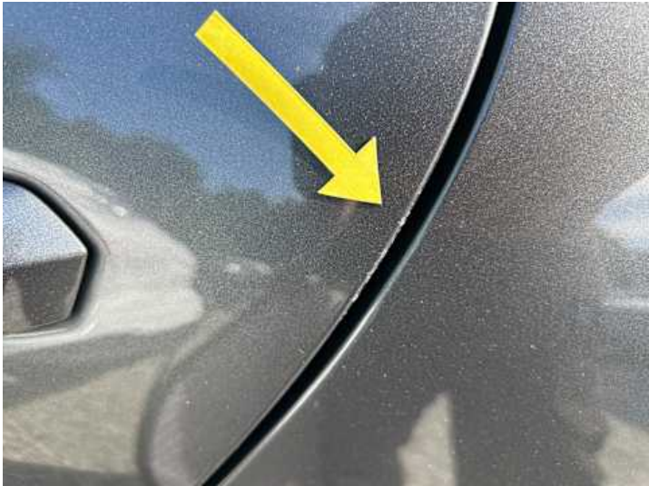
Türe hinten links (Lackschaden)
