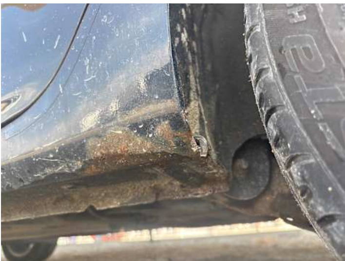
Schweller links (Rost)
