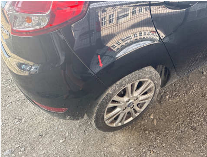
Seitenteil hinten rechts (Delle, Lackschaden, Kratzer)
