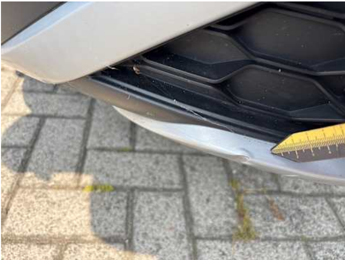
Stoßstange vorne (Delle)
