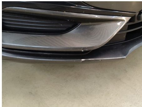
Zierrahmen Nebelscheinwerfer / Vorne Rechts / Kratzer
