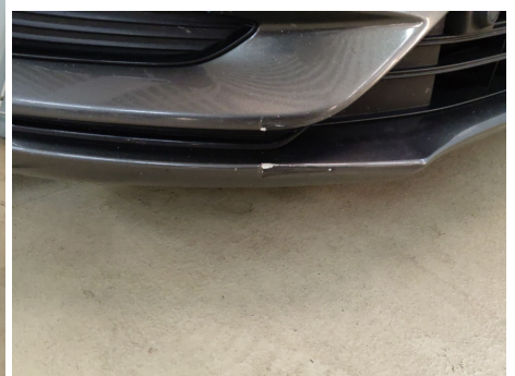
Stoßfänger / Vorne Rechts / Kratzer
