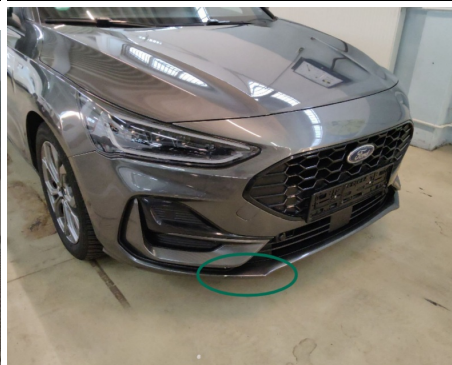
Stoßfänger / Vorne Rechts / Kratzer
