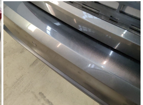
Stoßfänger / Hinten / Kratzer
