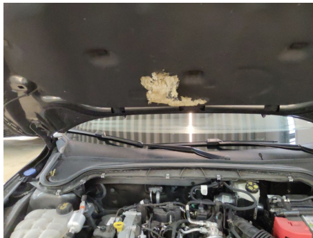
Geräuschdämmung Motorhaube / Vorne / Gebrochen
