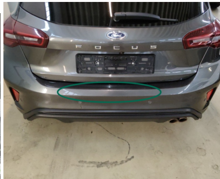
Stoßfänger / Hinten / Kratzer
