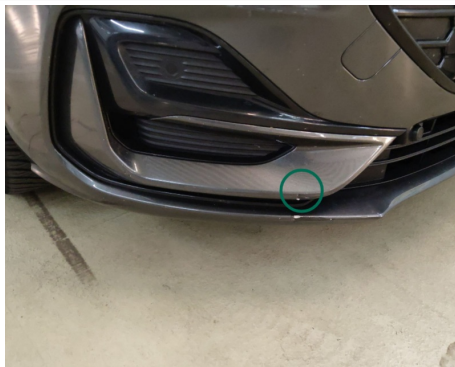
Zierrahmen Nebelscheinwerfer / Vorne Rechts / Kratzer
