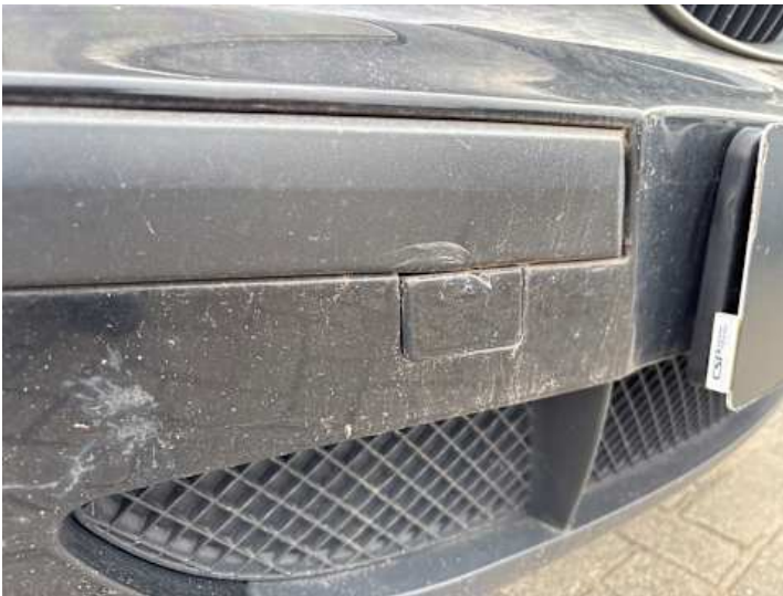
Stoßstange vorne (Lackschaden, Spaltmaße ungenau, Kratzer)
