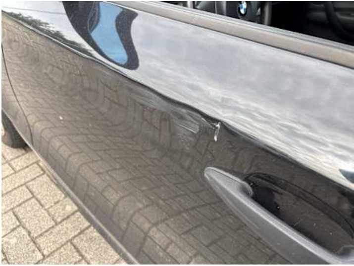
Fahrertür (Lackschaden, Kratzer, Verformung)
