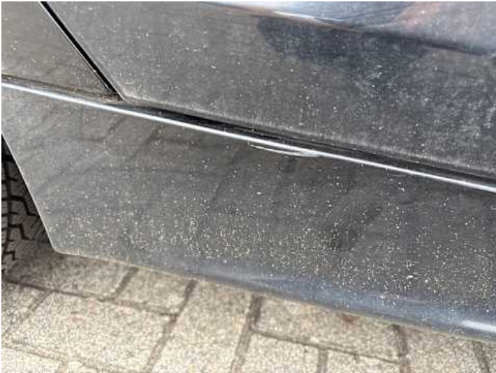
Schweller rechts (Lackschaden, Kratzer)
