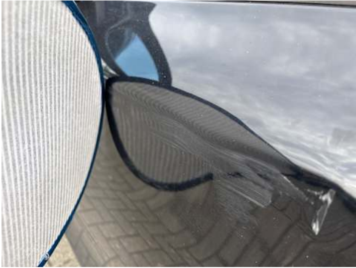
Fahrertür (Lackschaden, Kratzer, Verformung)
