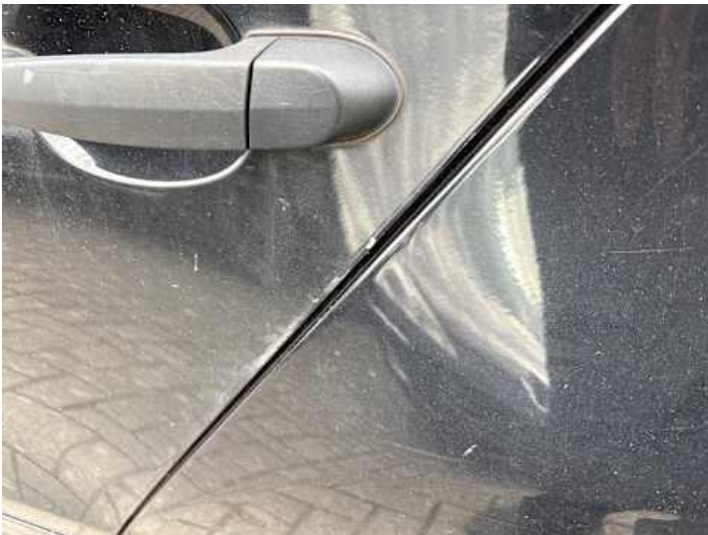
Türe hinten links (Lackschaden, Kratzer)
