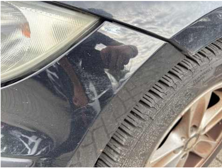
Stoßstange vorne (Lackschaden, Spaltmaße ungenau, Kratzer)
