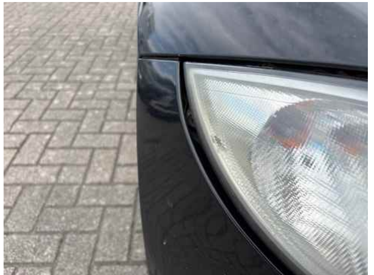
Stoßstange vorne (Lackschaden, Spaltmaße ungenau, Kratzer)
