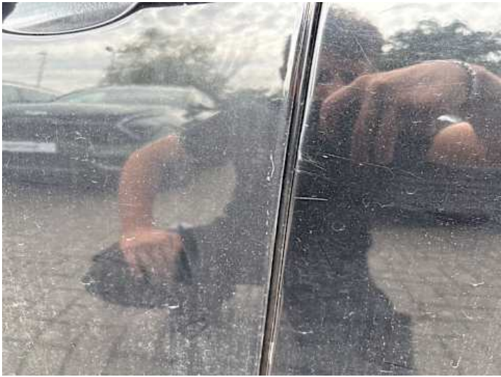
Fahrertür (Lackschaden, Kratzer, Verformung)
