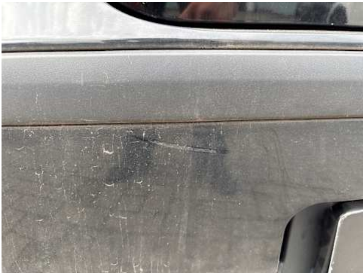
Stoßstange hinten (Lackschaden, Kratzer)
