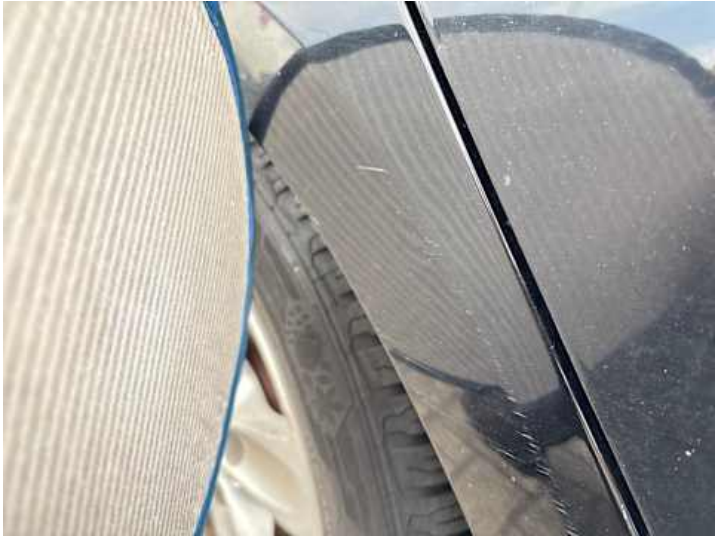
Seitenteil hinten rechts (Kratzer, Lackschaden, Delle)
