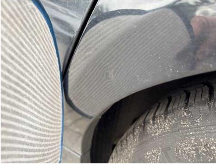
Seitenteil hinten links (Delle)
