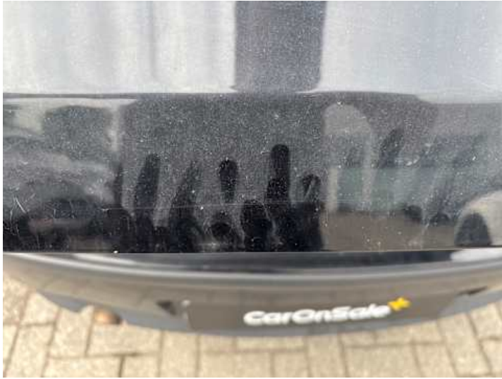
Heckklappe (Kratzer, Lackschaden)
