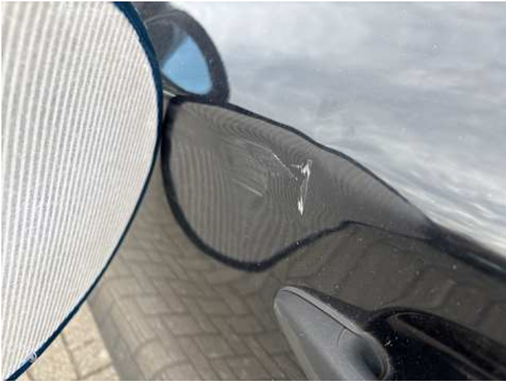
Fahrertür (Lackschaden, Kratzer, Verformung)
