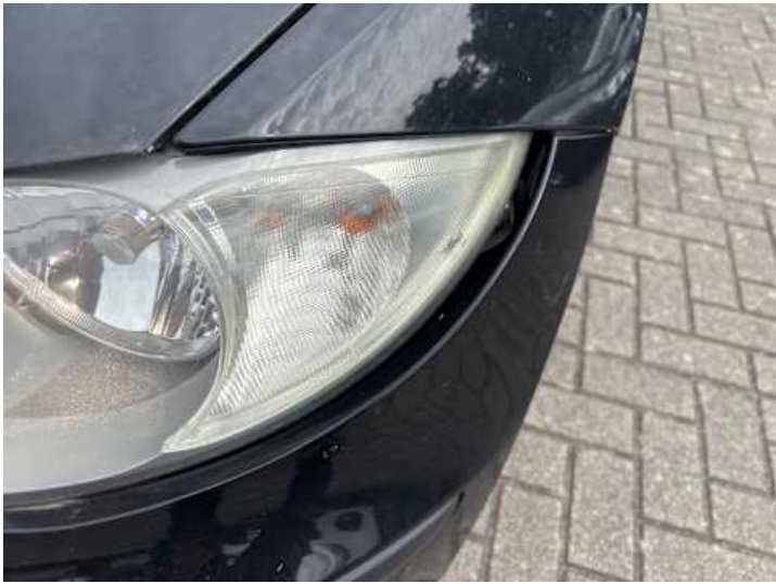
Stoßstange vorne (Lackschaden, Spaltmaße ungenau, Kratzer)
