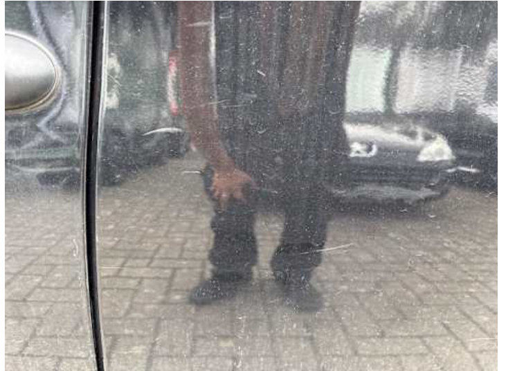
Türe hinten links (Lackschaden, Kratzer)
