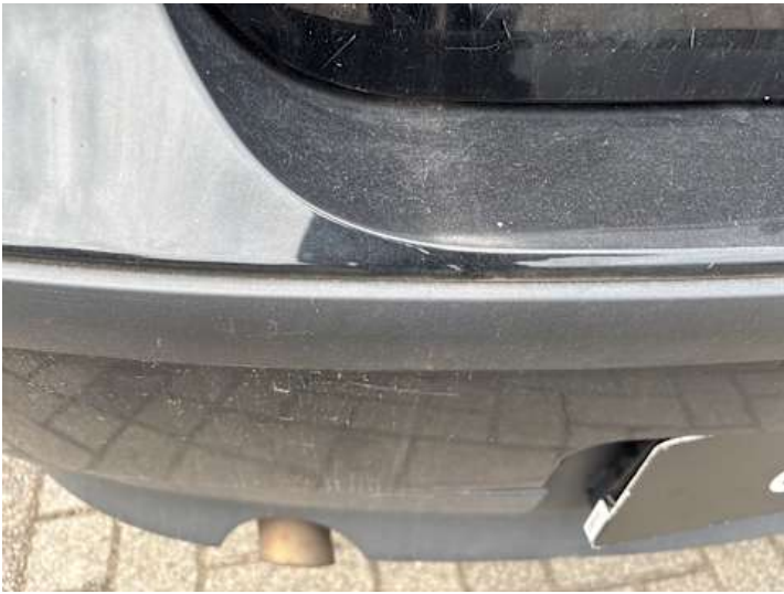
Stoßstange hinten (Lackschaden, Kratzer)
