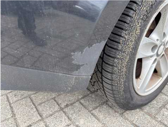
Stoßstange hinten (Lackschaden, Kratzer)
