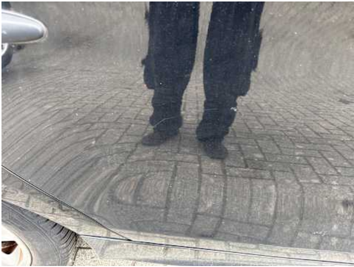
Türe hinten rechts (Kratzer, Lackschaden)
