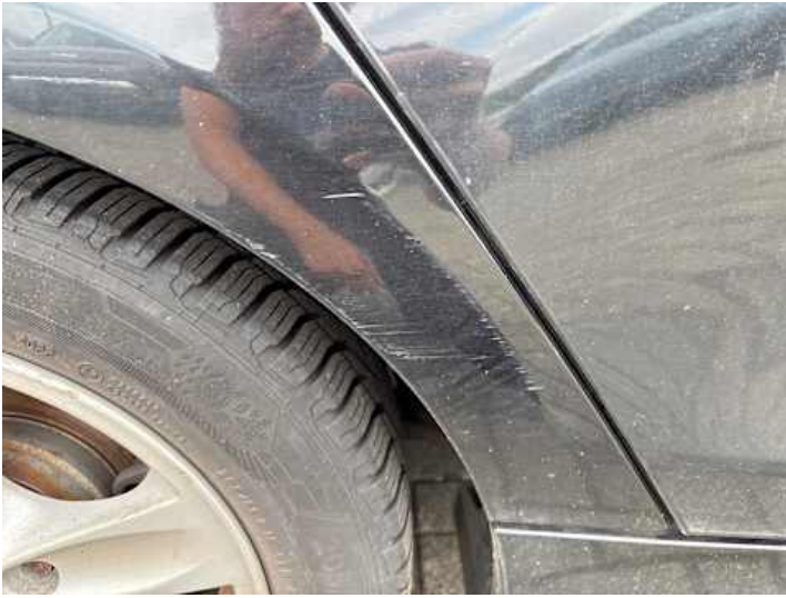
Seitenteil hinten rechts (Kratzer, Lackschaden, Delle)
