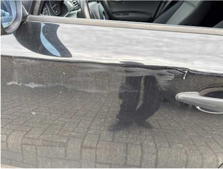
Fahrertür (Lackschaden, Kratzer, Verformung)
