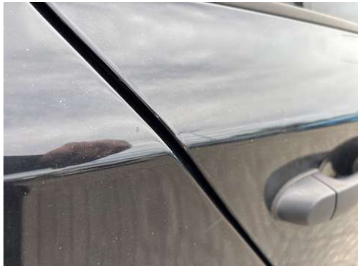
Türe hinten rechts (Kratzer, Lackschaden)
