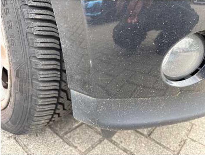
Stoßstange vorne (Lackschaden, Spaltmaße ungenau, Kratzer)
