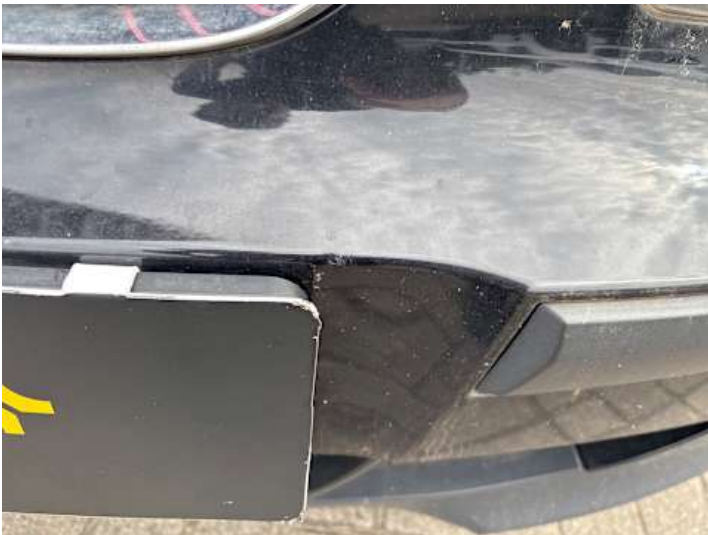
Stoßstange vorne (Lackschaden, Spaltmaße ungenau, Kratzer)
