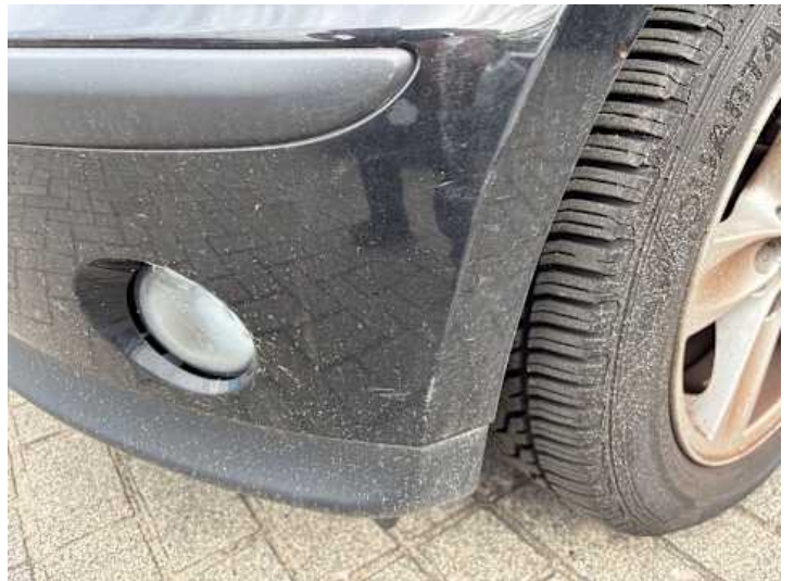
Stoßstange vorne (Lackschaden, Spaltmaße ungenau, Kratzer)
