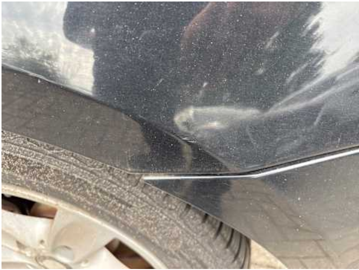
Seitenteil hinten links (Delle)
