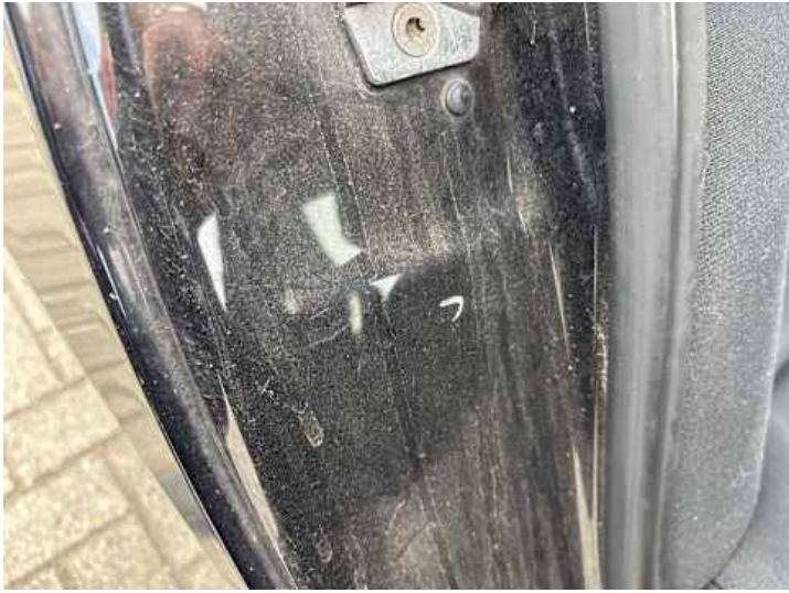
Seitenteil hinten rechts (Lackschaden, Delle)
