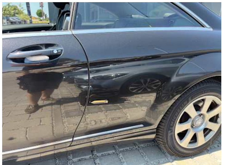
Seitenteil hinten links (Rost, Lackschaden, Kratzer)
