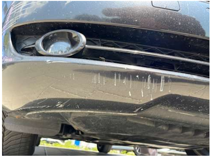
Stoßstange vorne (Kratzer, Lackschaden)
