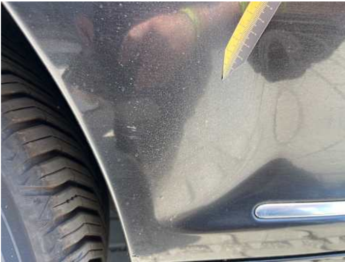
Seitenteil hinten rechts (Lackschaden, Rost)
