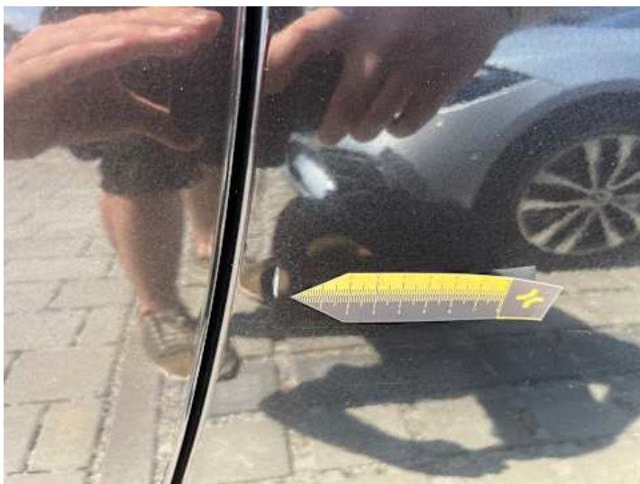
Seitenteil hinten links (Rost, Lackschaden, Kratzer)
