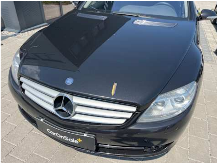
Motorhaube (Steinschlag, Unsachgemäß instand gesetzt)
