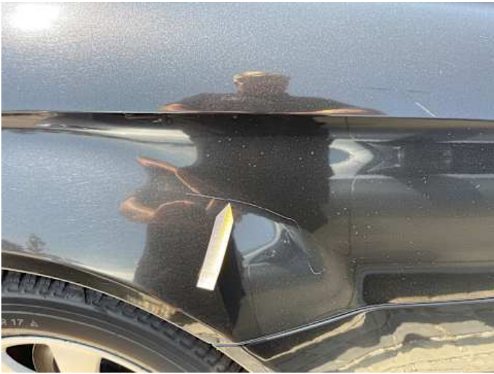
Seitenteil hinten links (Rost, Lackschaden, Kratzer)
