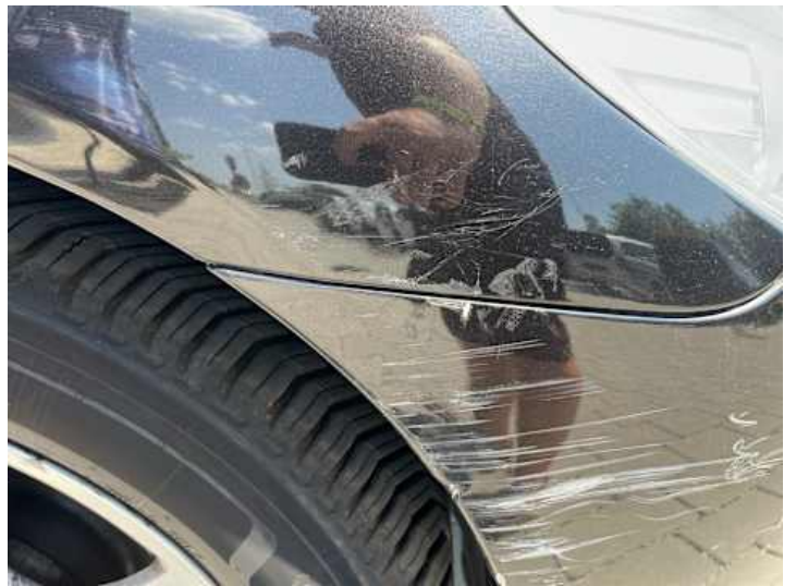
Kotflügel vorne rechts (Lackschaden, Kratzer, Unsachgemäß instand gesetzt)
