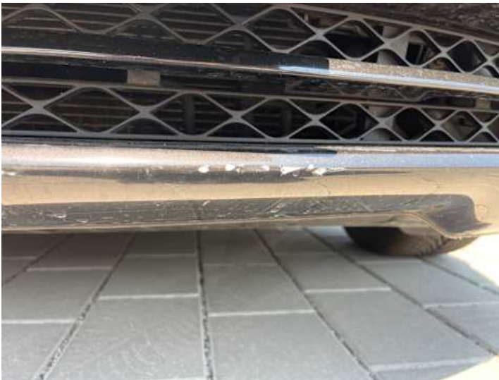
Stoßstange vorne (Kratzer, Lackschaden)
