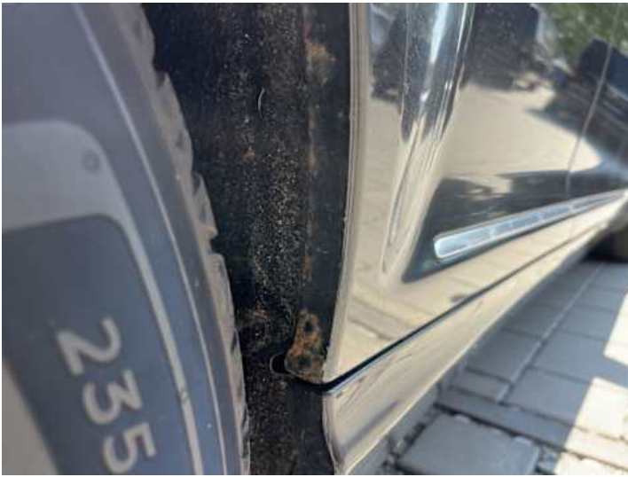
Seitenteil hinten rechts (Lackschaden, Rost)
