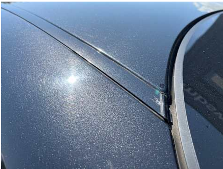
Seitenteil hinten links (Lackschaden, Rost)
