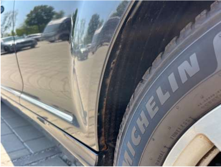
Seitenteil hinten links (Rost, Lackschaden, Kratzer)
