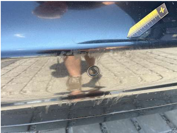
Stoßstange hinten (Kratzer, Lackschaden)
