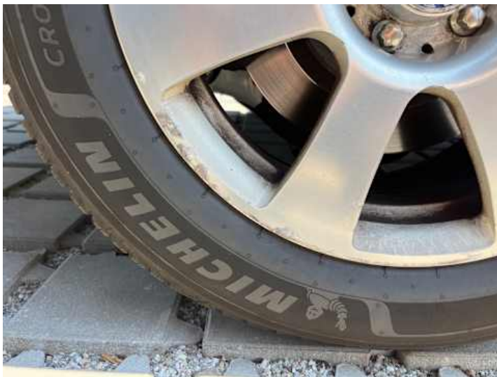
Rad (Kerben, Rost)
