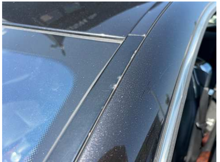
Seitenteil hinten links (Lackschaden, Rost)
