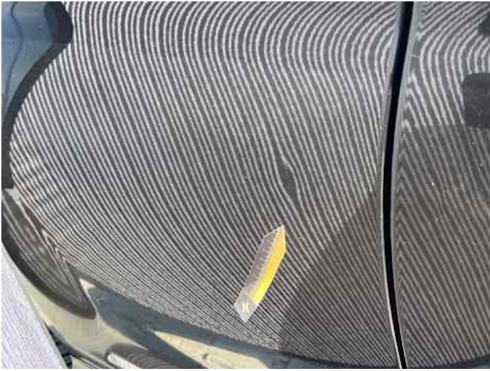
Seitenteil hinten rechts (Verformung)
