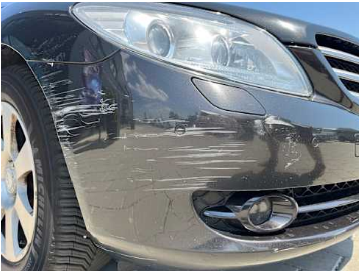
Stoßstange vorne (Kratzer, Lackschaden)
