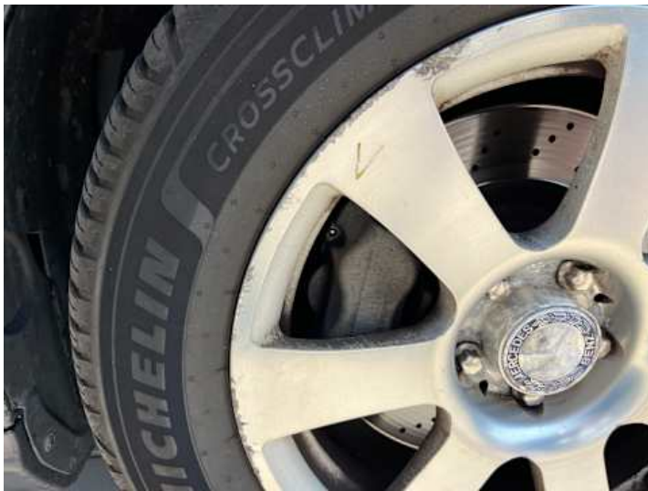
Rad (Kerben, Rost)
