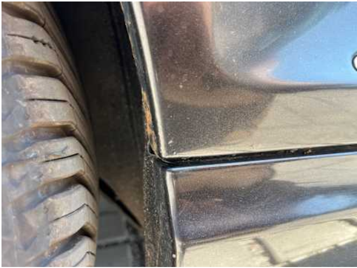
Seitenteil hinten rechts (Lackschaden, Rost)
