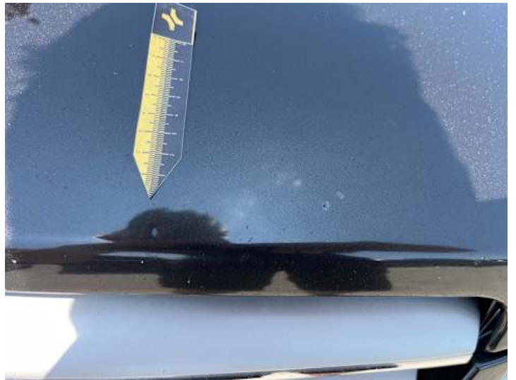
Motorhaube (Steinschlag, Unsachgemäß instand gesetzt)
