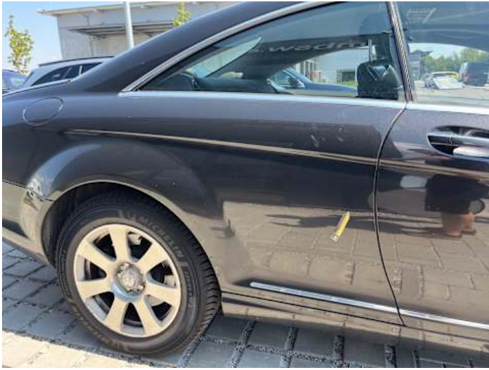
Seitenteil hinten rechts (Verformung)
