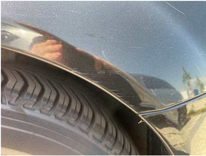
Seitenteil hinten links (Rost, Lackschaden, Kratzer)
