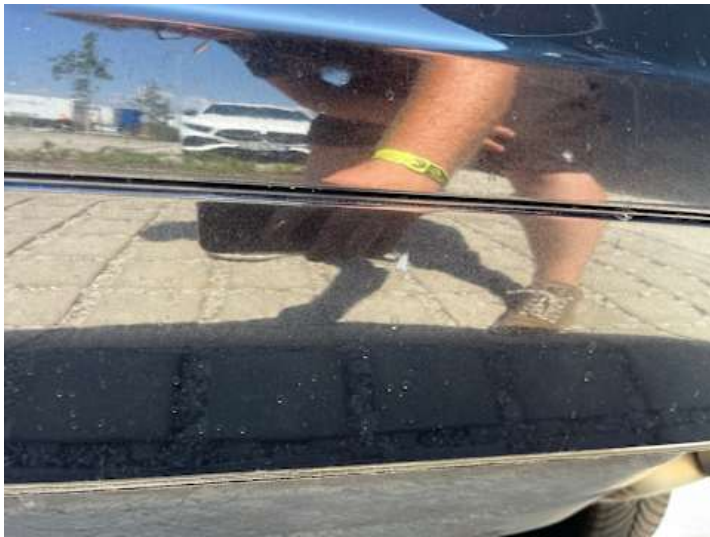
Stoßstange hinten (Kratzer, Lackschaden)
