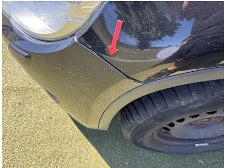
Stoßstange vorne (Spaltmaße ungenau)
