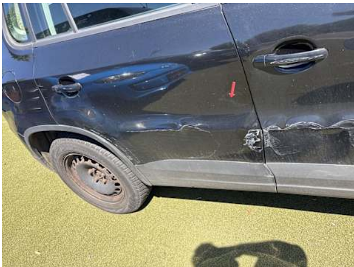
Türe hinten rechts (Lackschaden, Verformung)
