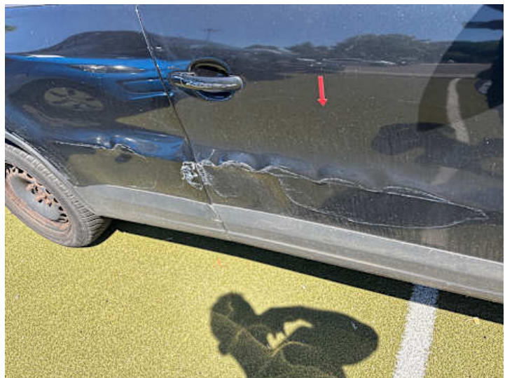
Beifahrtür (Lackschaden, Verformung)
