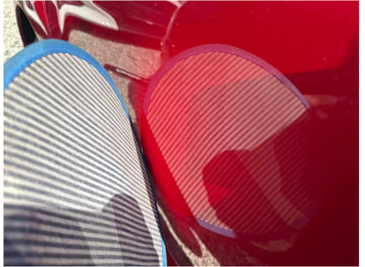
Türe hinten rechts (Delle)
