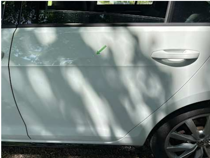
Türe hinten links (Delle, Kratzer)
