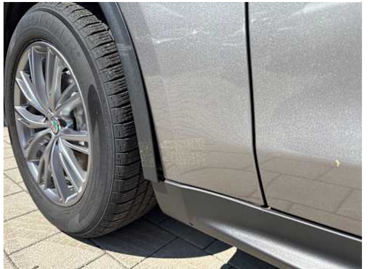
Kotflügel vorne links (Spaltmaße ungenau, Unsachgemäß instand gesetzt)
