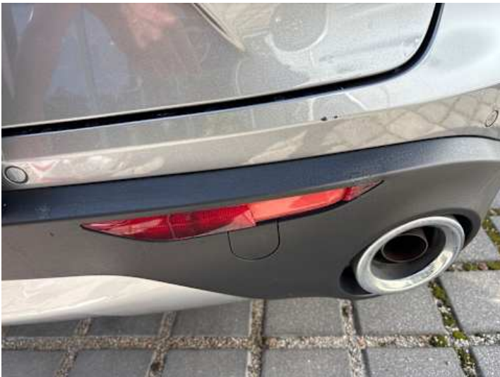
Stoßstange hinten (Riss/Bruch, Lackschaden, Kratzer)
