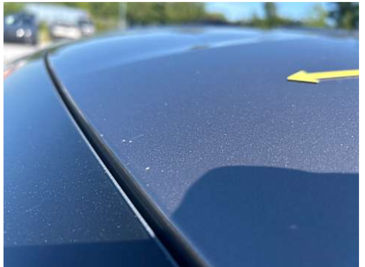
Dach (Lackschaden, Steinschlag)
