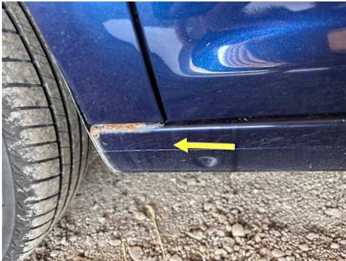
Schweller links (Rost)
