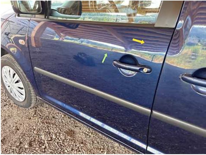
Fahrtür (Delle, Kratzer)
