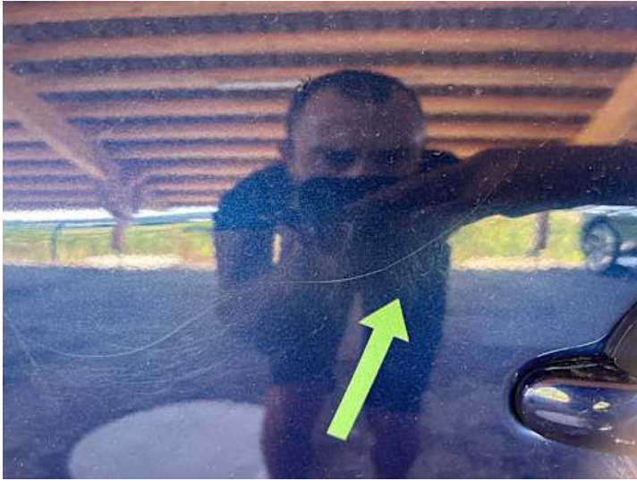
Fahrtür (Delle, Kratzer)
