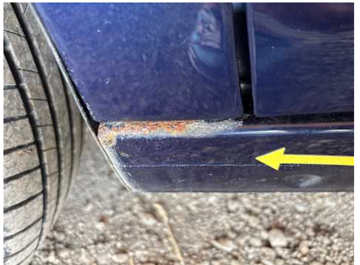
Schweller links (Rost)
