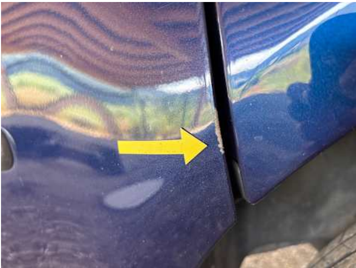
Türe hinten links (Lackschaden)
