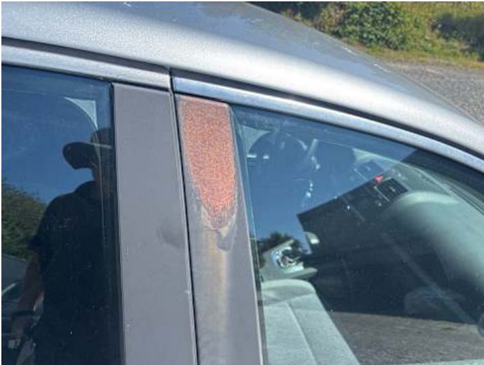
Beifahrtür (Rost, Lackschaden)
