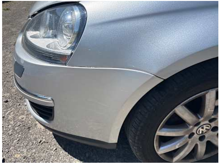
Stoßstange vorne (Unsachgemäß instand gesetzt)
