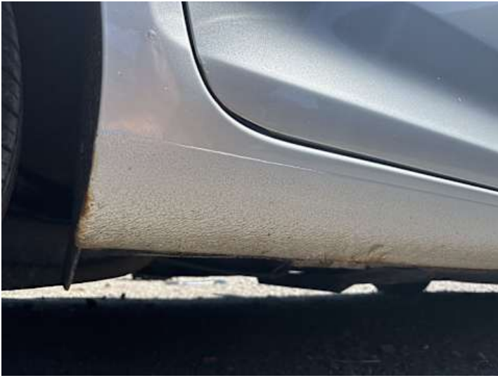
Schweller rechts (Rost)
