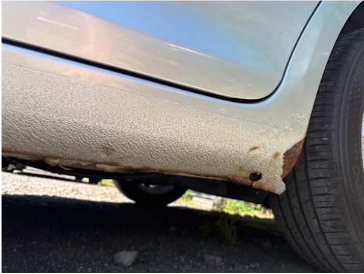
Schweller links (Rost)
