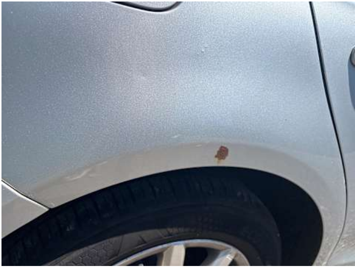
Seitenteil hinten rechts (Rost)
