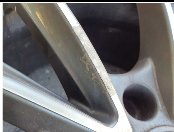
Beschädigung #7: 2.Radsatz: 2.Radsatz - verkratzt / verschürft - Wertminderung
