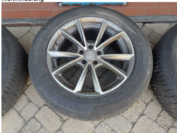
Beschädigung #7: 2.Radsatz: 2.Radsatz - verkratzt / verschürft - Wertminderung
