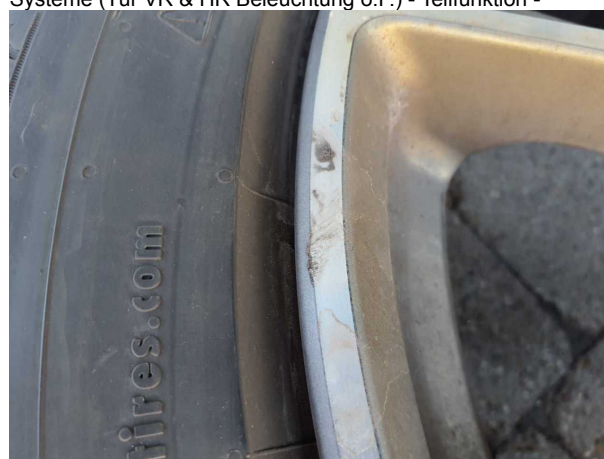
Beschädigung #7: 2.Radsatz: 2.Radsatz - verkratzt / verschürft - Wertminderung
