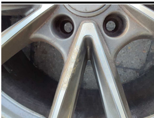
Beschädigung #7: 2.Radsatz: 2.Radsatz - verkratzt / verschürft - Wertminderung
