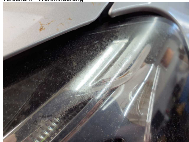
Beschädigung #11: Scheinwerfer: Scheinwerfer links - unzulässig - erneuern
