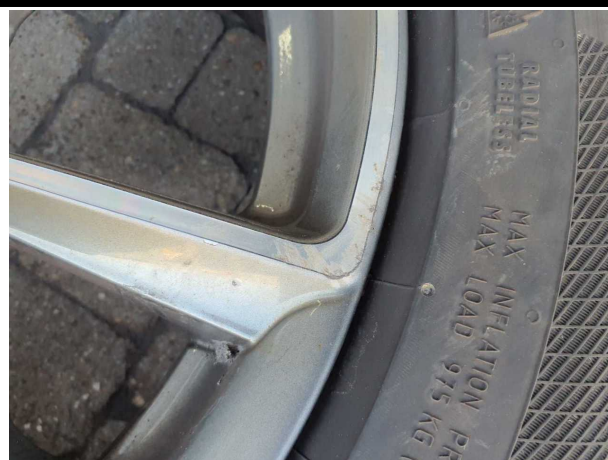
Beschädigung #7: 2.Radsatz: 2.Radsatz - verkratzt / verschürft - Wertminderung
