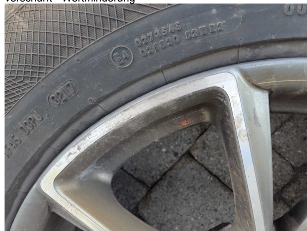
Beschädigung #7: 2.Radsatz: 2.Radsatz - verkratzt / verschürft - Wertminderung
