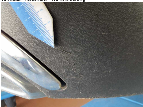
Beschädigung #4: Stossfänger hinten: Stossfänger hinten - verkratzt / verschürft - Wertminderung
