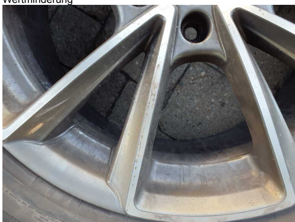
Beschädigung #7: 2.Radsatz: 2.Radsatz - verkratzt / verschürft - Wertminderung
