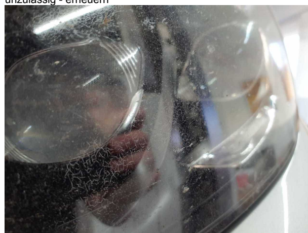
Beschädigung #11: Scheinwerfer: Scheinwerfer links - unzulässig - erneuern
