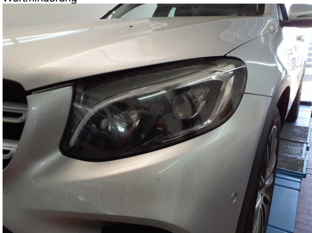
Beschädigung #11: Scheinwerfer: Scheinwerfer links - unzulässig... erneuern
