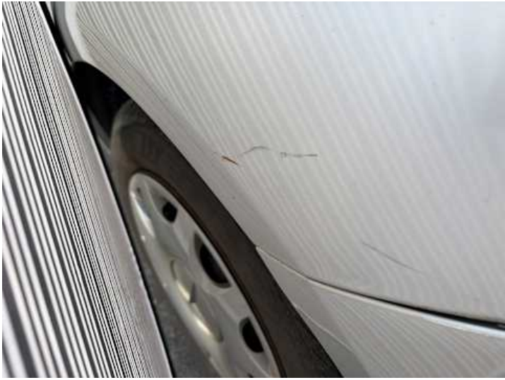
Seitenteil hinten links (Kratzer, Delle, Rost)
