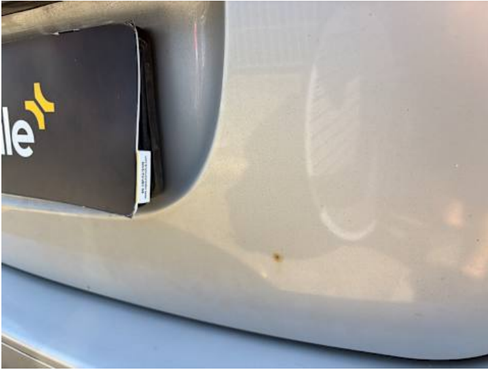
Heckklappe (Rost, Kratzer)
