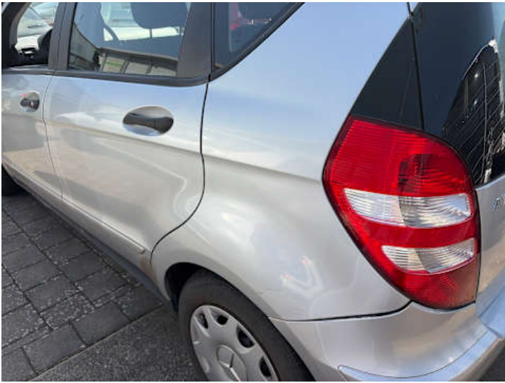
Seitenteil hinten links (Kratzer, Delle, Rost)
