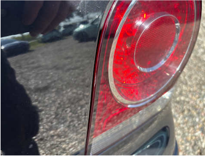
Rücklicht (rechts) (Riss/Bruch)
