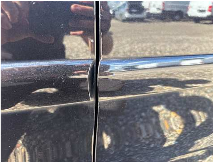
Beifahrertür (Lackschaden, Kratzer)
