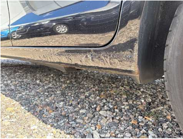
Schweller links (Rost)
