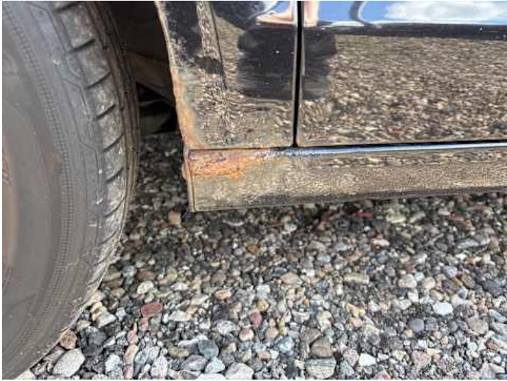
Schweller links (Rost)
