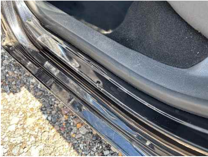
Schweller links (Lackschaden, Delle)
