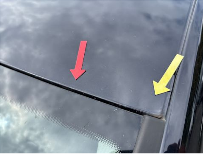
Dach (Rost, Lackschaden)
