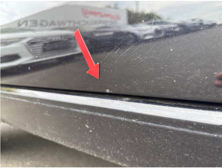
Türe hinten rechts (Rost)
