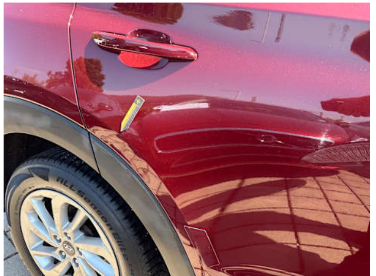
Türe hinten rechts (Verformung)
