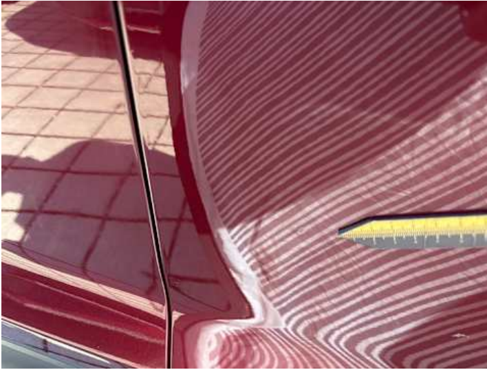
Beifahrertür (Unsachgemäß instand gesetzt)
