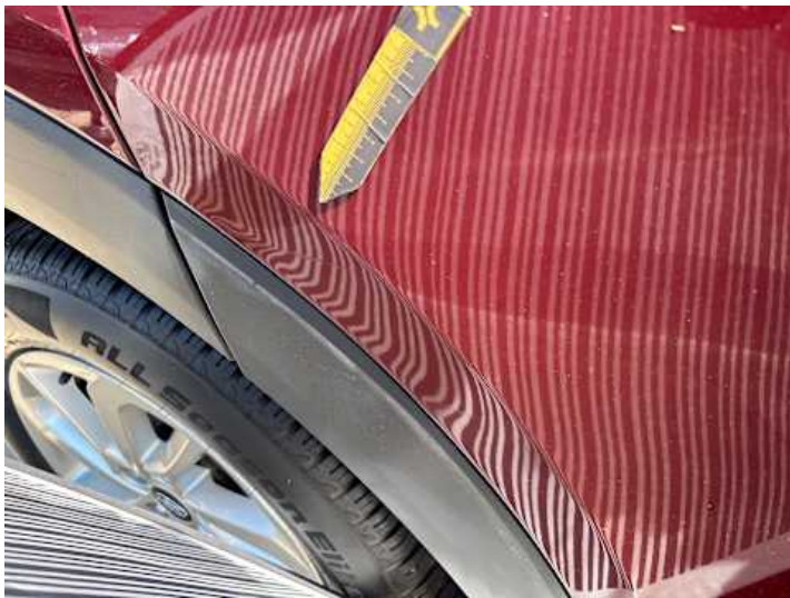
Türe hinten rechts (Verformung)
