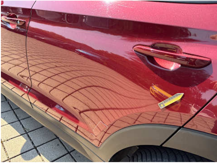
Türe hinten links (Delle)
