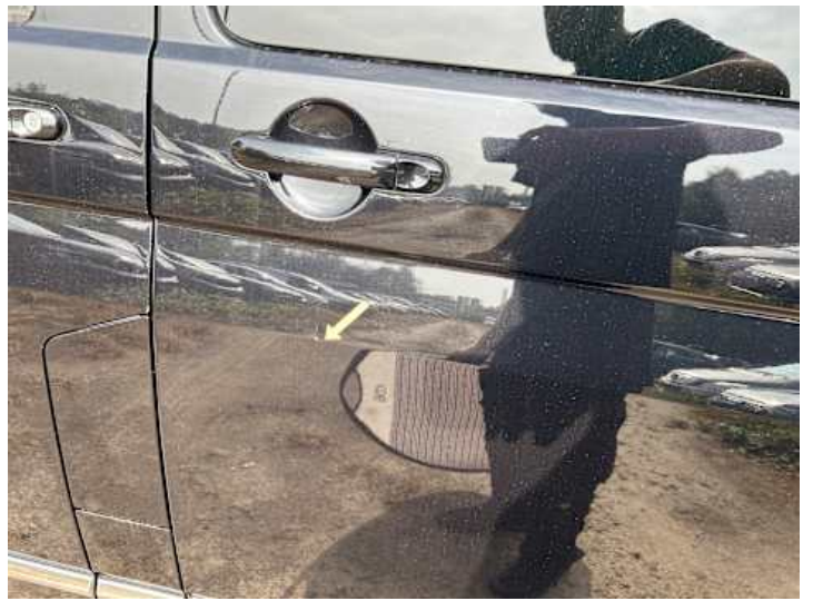
Türe hinten links (Delle, Lackschaden)
