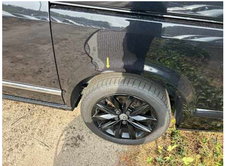
Seitenteil hinten links (Lackschaden)
