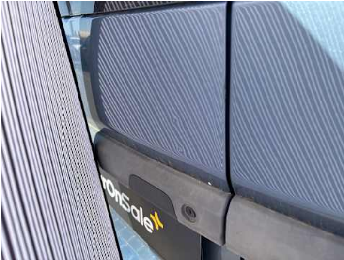
Heckklappe (Kratzer, Delle)
