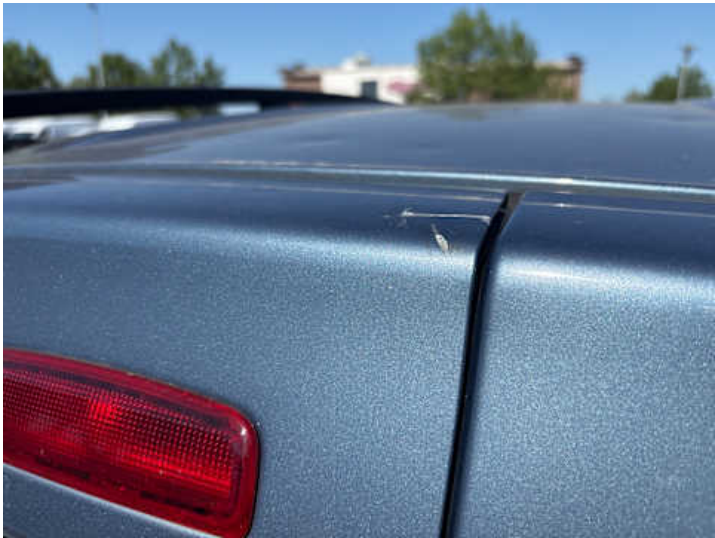
Heckklappe (Kratzer, Delle)
