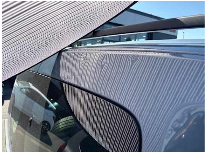
Türe hinten rechts (Delle)
