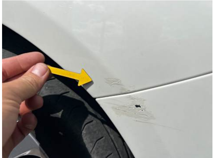
Kotflügel vorne rechts (Kratzer, Unsachgemäß instand gesetzt)
