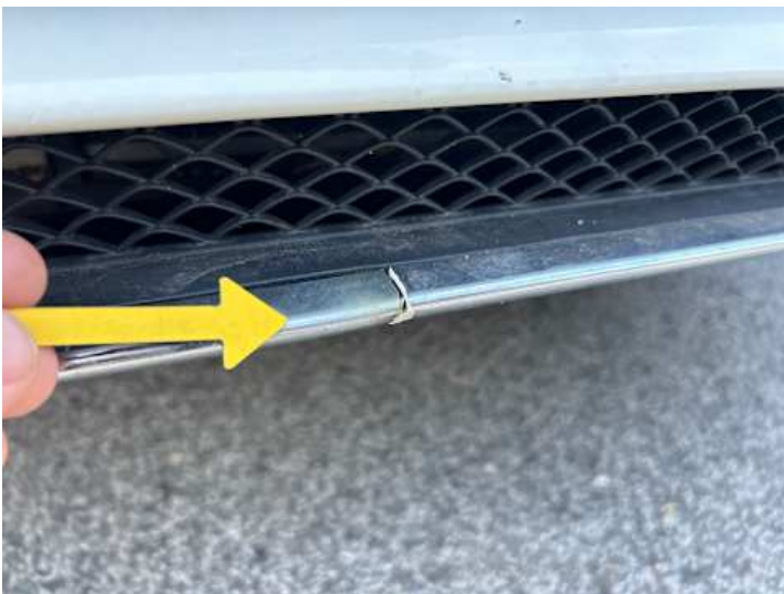
Stoßstange vorne (Riss/Bruch)
