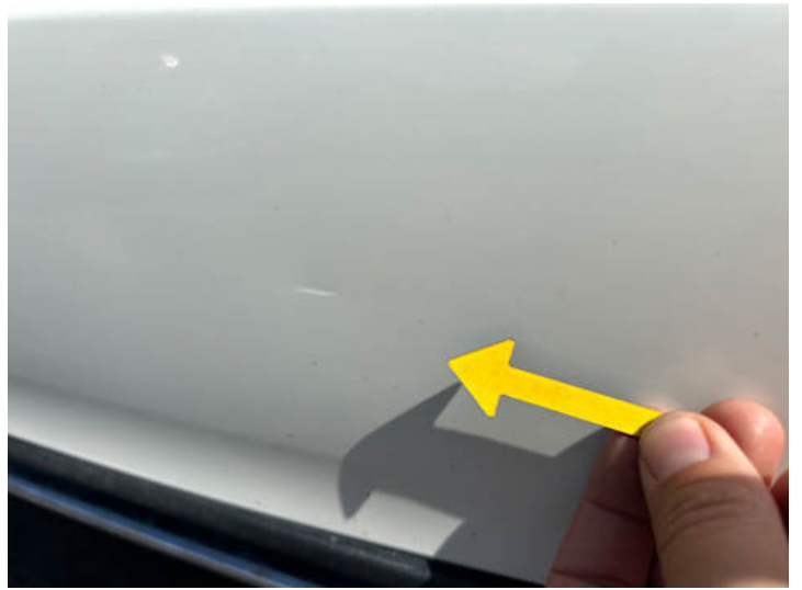
Stoßstange hinten (Kratzer, Verformung, Spaltmaße ungenau)
