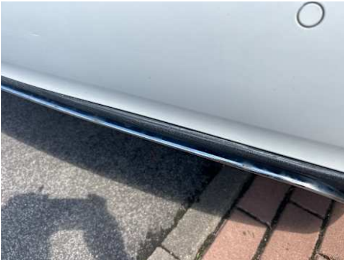
Stoßstange hinten (Kratzer, Verformung, Spaltmaße ungenau)
