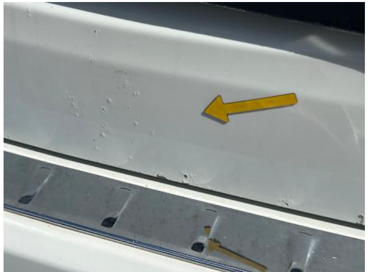
Heckklappe (Kratzer, Rost)
