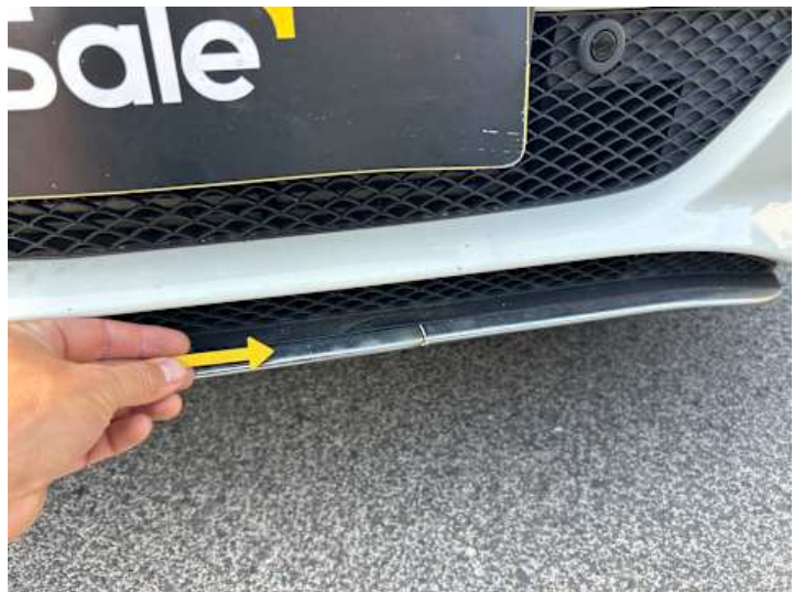
Stoßstange vorne (Riss/Bruch)
