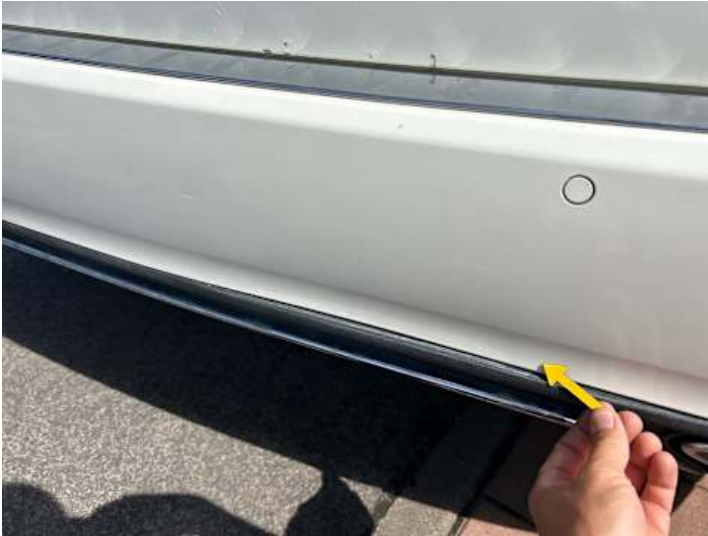
Stoßstange hinten (Kratzer, Verformung, Spaltmaße ungenau)
