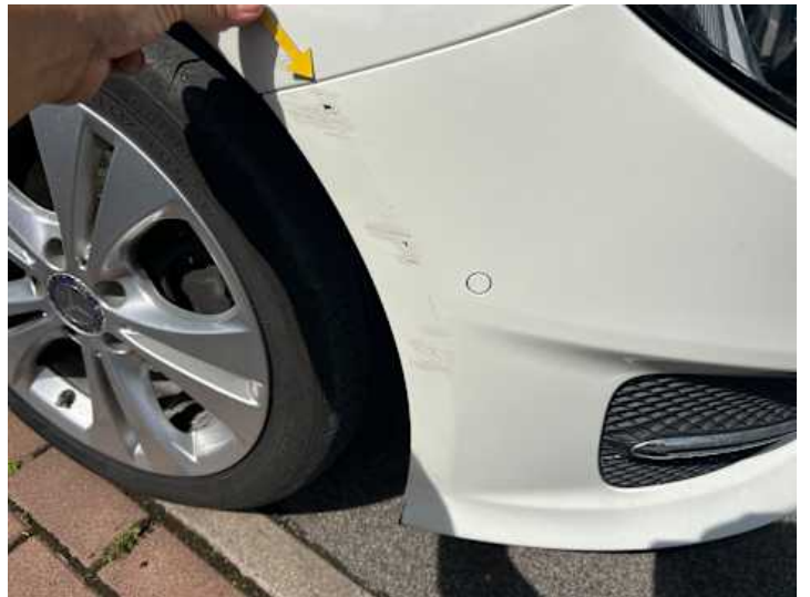
Stoßstange vorne (Kratzer, Verformung, Unsachgemäß instand gesetzt)
