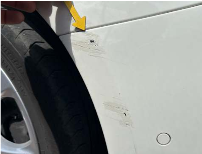
Stoßstange vorne (Kratzer, Verformung, Unsachgemäß instand gesetzt)
