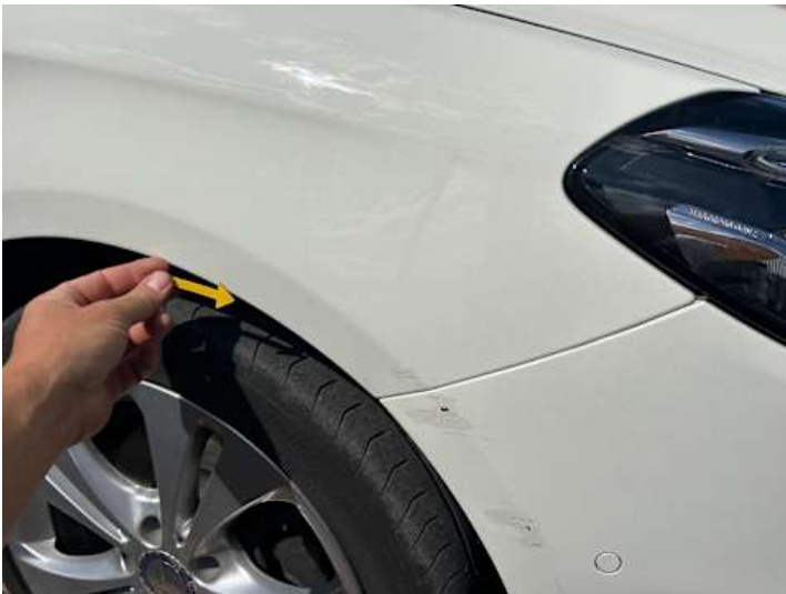
Kotflügel vorne rechts (Kratzer, Unsachgemäß instand gesetzt)
