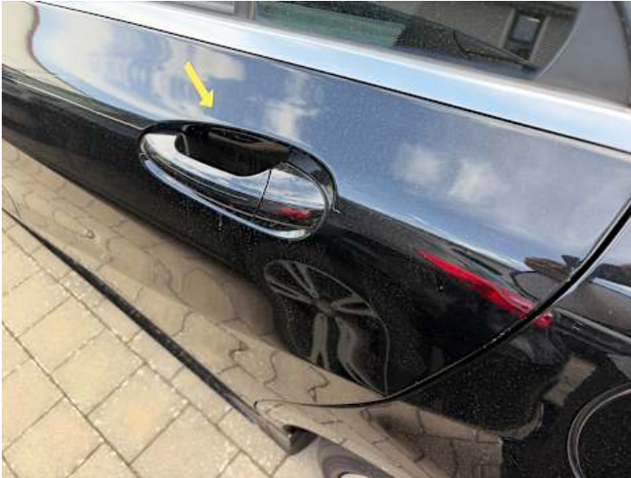
Türe hinten links (Kratzer)
