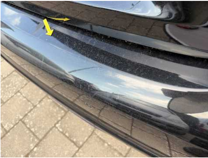
Stoßstange hinten (Kratzer)
