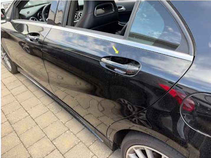
Türe hinten links (Kratzer)
