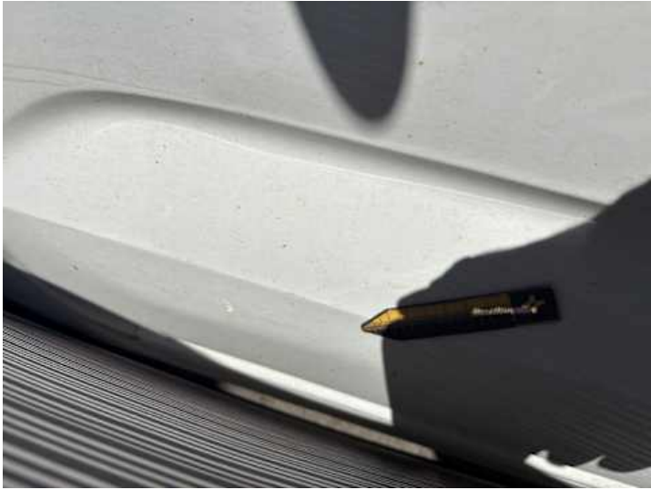
Türe hinten rechts (Verformung)
