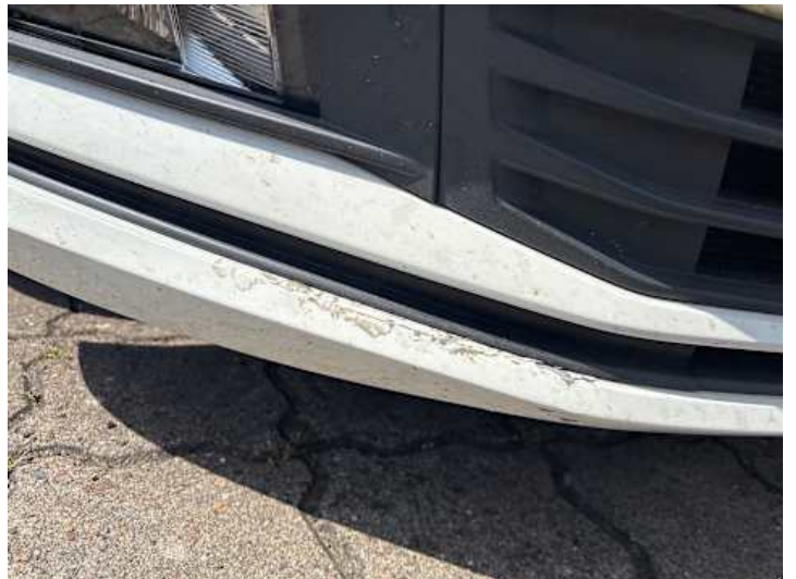
Stoßstange vorne (Riss/Bruch)
