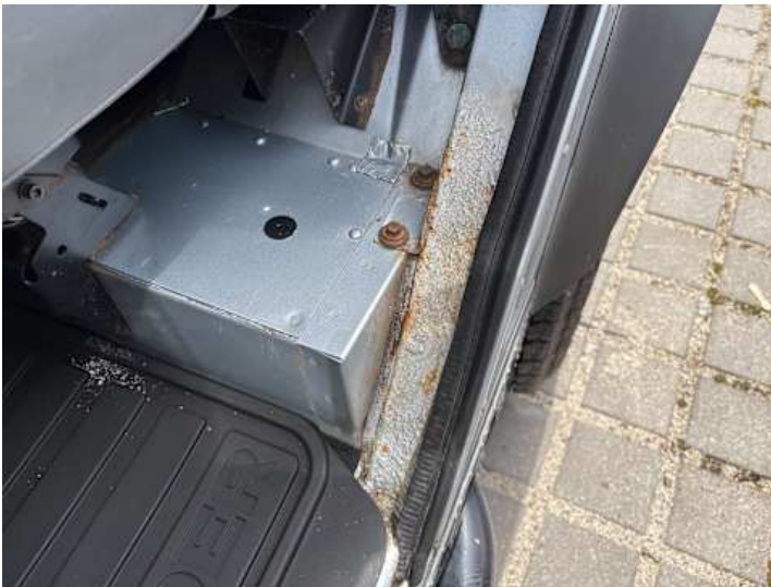
Türe hinten links (Rost, Lackschaden)
