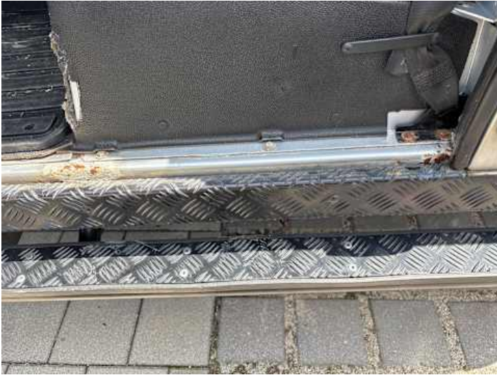
Fahrertür (Rost, Lackschaden)
