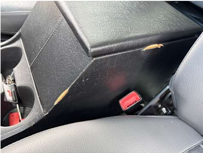
Innenraum (Verschleiß, Riss/Bruch)
