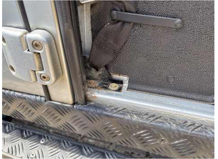
Beifahrertür (Rost, Lackschaden)
