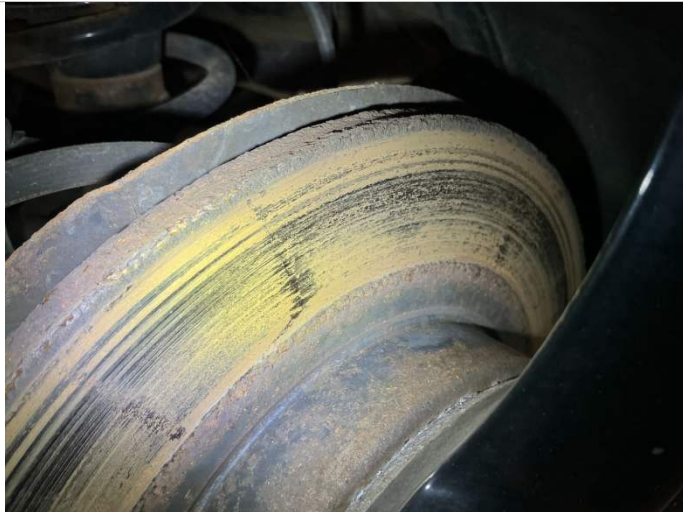
Bremsscheiben hinten Tragbild mangelhaft.
