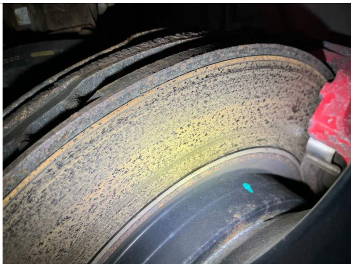
Bremsscheiben vorn Tragbild mangelhaft.
