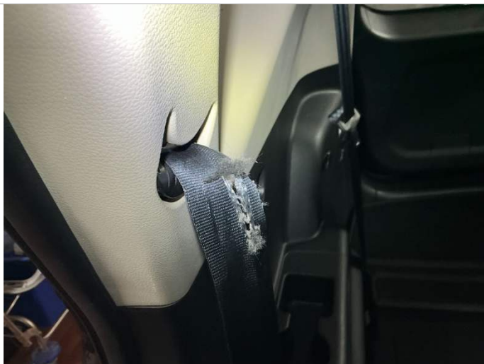
Sicherheitsgurt hinten rechts beschädigt.
