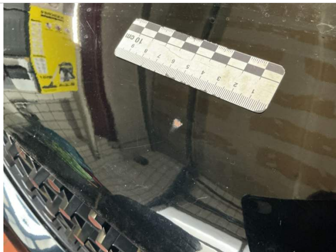
Motorhaube Kratzer und Lackbeschädigung mit Rostbildung.
