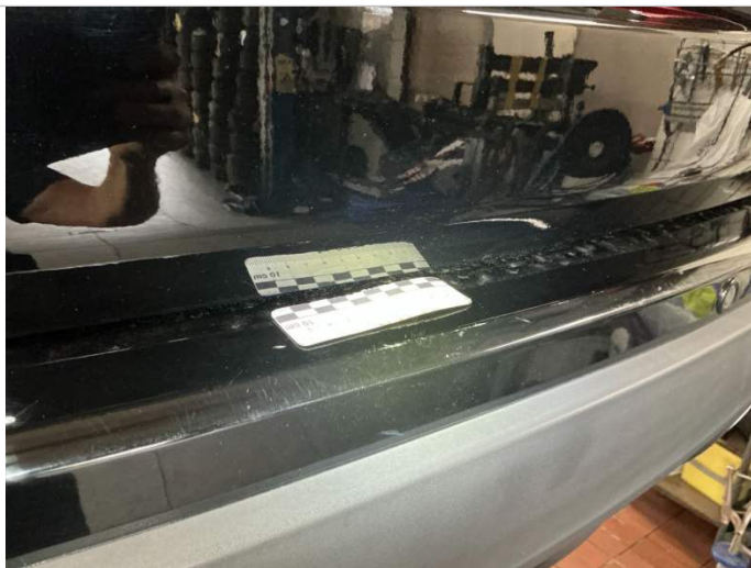
Stoßfänger hinten Kratzer.
