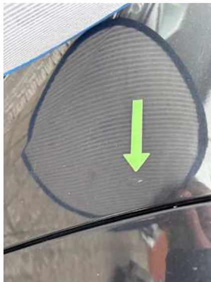
Seitenteil hinten rechts (Delle)
