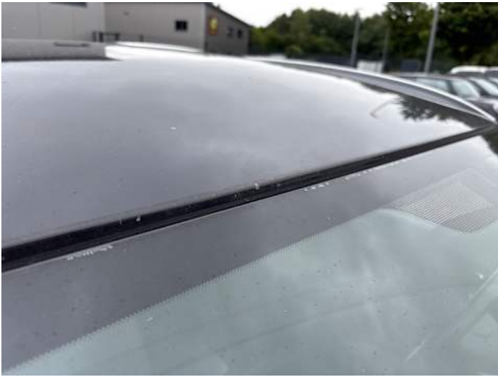
Dach (Steinschlag, Rost)
