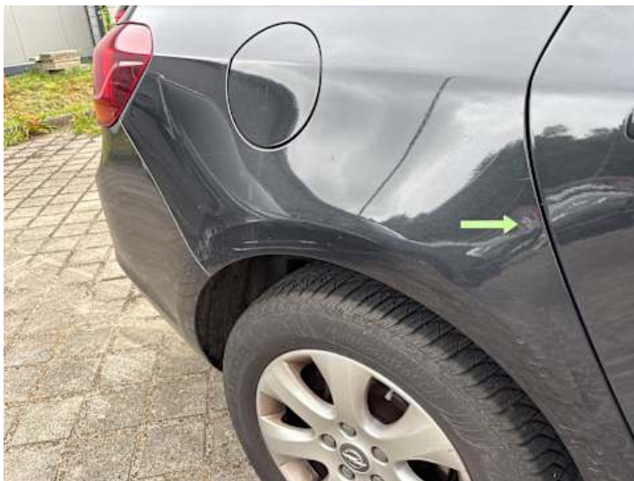
Seitenteil hinten rechts (Delle)
