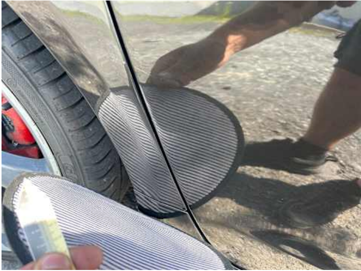
Seitenteil hinten rechts (Unsachgemäß instand gesetzt)
