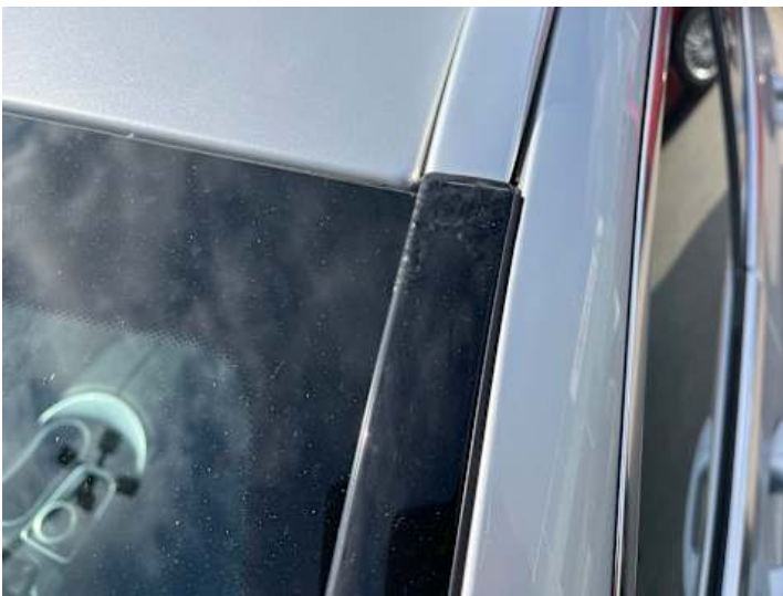
Windschutzscheibe (Anderer Schaden): Leisten haben Korrosionsschäden
