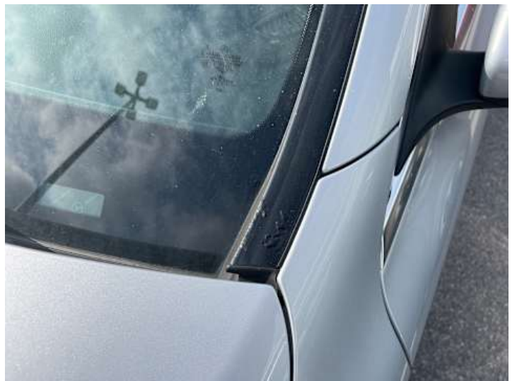
Windschutzscheibe (Anderer Schaden): Leisten haben Korrosionsschäden
