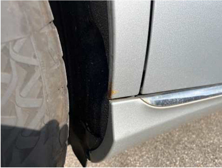
Seitenteil hinten rechts (Rost)
