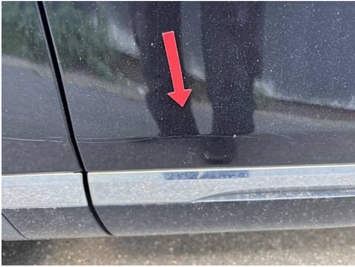
Fahrertür (Kratzer, Delle, Lackschaden)
