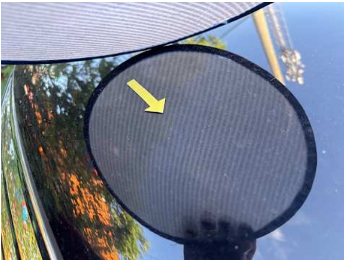
Motorhaube (Delle, Steinschlag)
