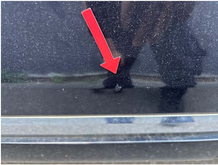
Fahrentür (Kratzer, Delle, Lackschaden)
