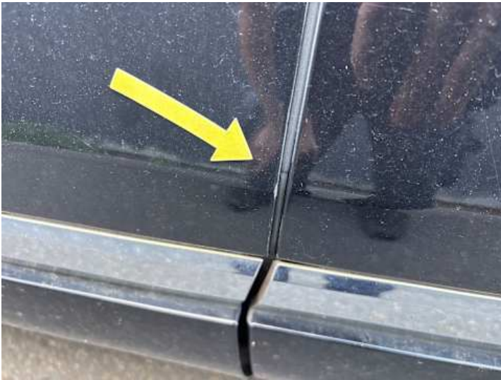
Fahrentür (Kratzer, Delle, Lackschaden)
