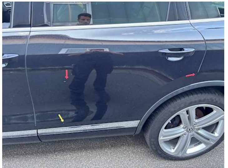
Türe hinten links (Lackschaden, Kratzer)
