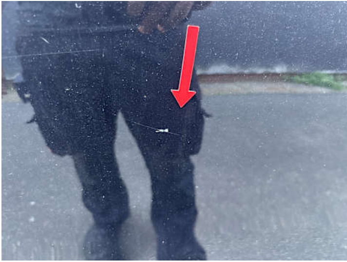
Türe hinten links (Lackschaden, Kratzer)
