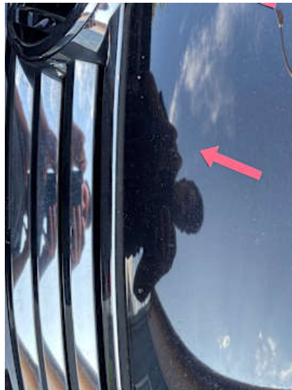
Motorhaube (Delle, Steinschlag)
