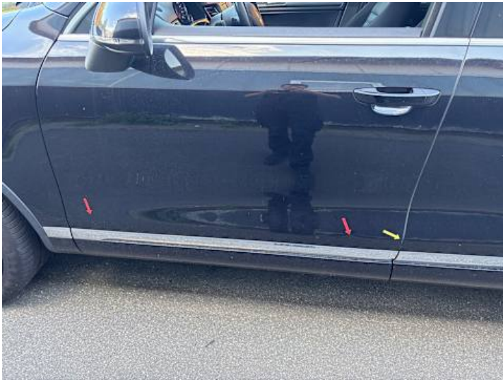
Fahrentür (Kratzer, Delle, Lackschaden)
