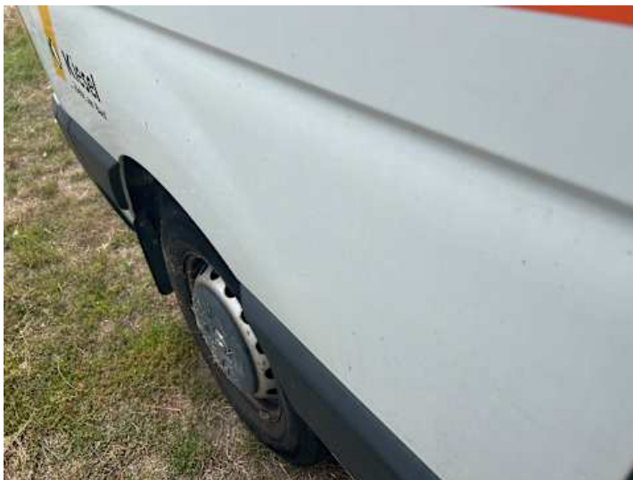
Seitenteil hinten rechts (Verformung)
